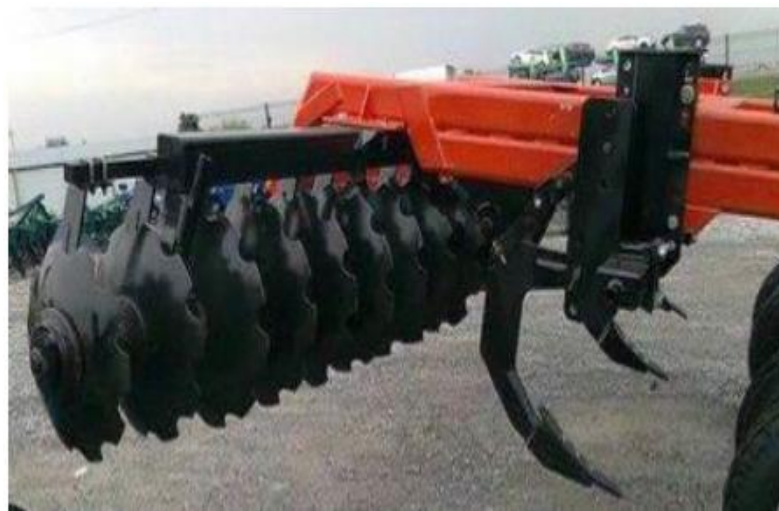
Рисунок 1.6 – Комбінований агрегат для пошарового обробітку ґрунту, дисколапова борона AGROLAND B20
