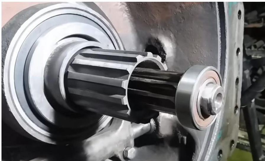
Рисунок 2.2 – Демонтаж підшипника, що повернувся.
