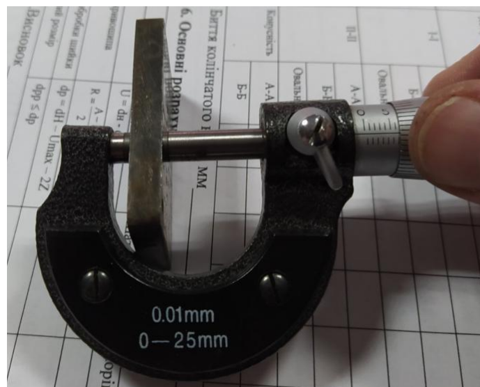
Рисунок 3.7 – Вимірювання товщини наплавленого шару.
