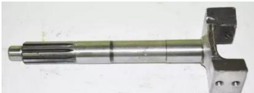
Рисунок 2.1 – Вал головного зчеплення (новий): загальний вигляд.
