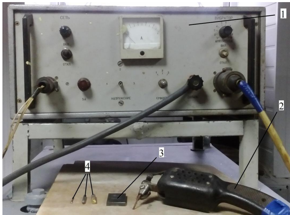
Рисунок 3.2 – ЕІЛ-установка «Елітрон-20»: 1) генератор; 2) вібратор; 3) експериментальний зразок; 4) електроди.
