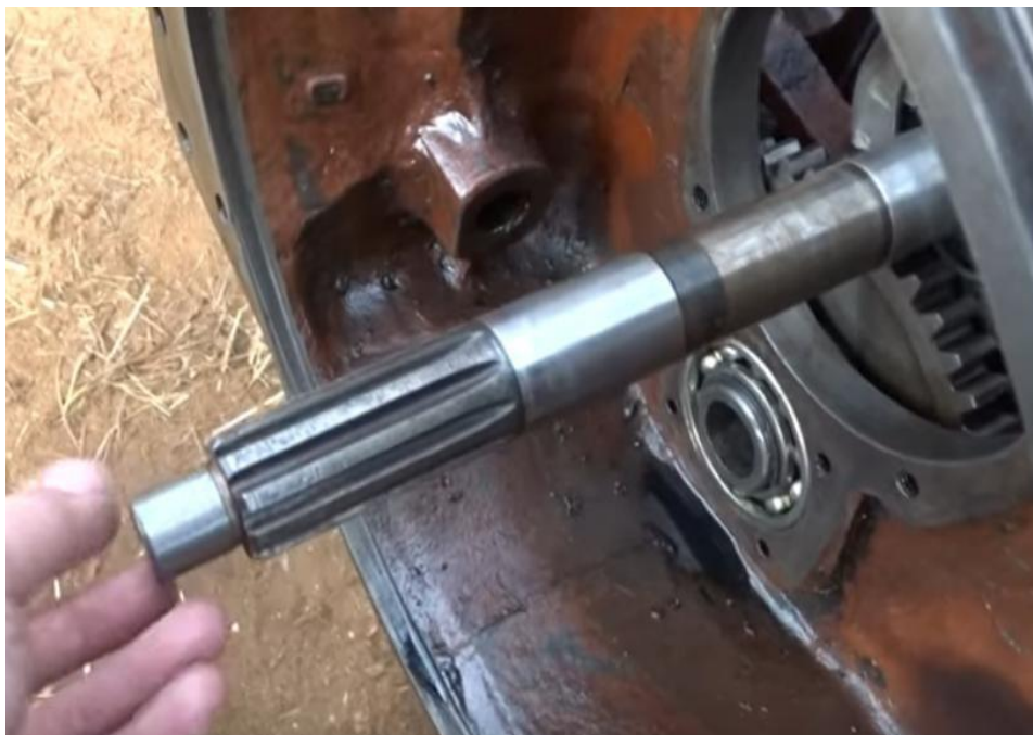
Рисунок 2.5 – Вал після відновлення та шліфування
