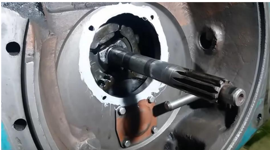
Рисунок 2.3 – Демонтаж вала головного зчеплення.
