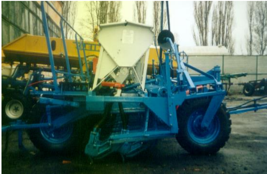
Рисунок 5.2 – Загальний вигляд зернотукової сівалки ЗС-3,6 конструкції КНТУ та ВАТ “Червона Зірка”
