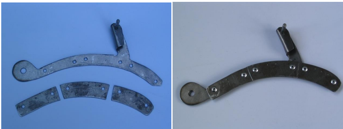
Рис. 2.5. Відбивач зайвого насіння зі змінними експериментальними робочими секторами
