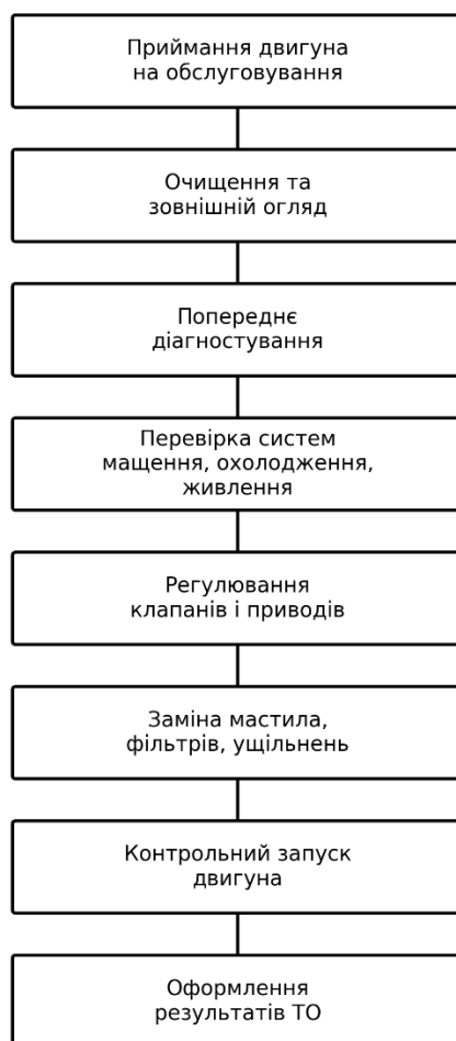
Рисунок 1.2 – Загальна схема технологічного процесу технічного обслуговування дизельного двигуна
