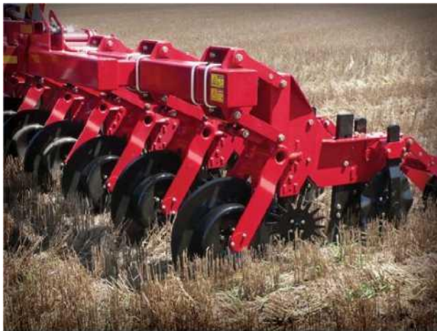
Рис.1.3 – Ротаційна борона у складі комбінованого агрегату
