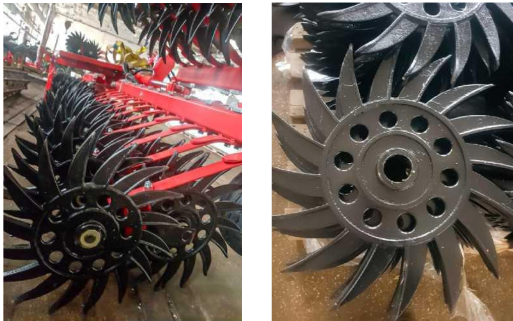
Рис.1.2.- Ротаційна борона «Динар», виробництва ПАТ «Лозовські машини»
