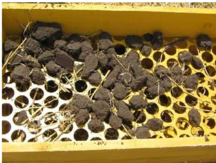
Рис.3.4. Сепарація поверхневого фракційного складу на решеті d = 50 мм.
