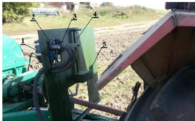
Рисунок 3.26 - Дослідний зразок стабілізуючого пристрою: де 1 - гідророзподільник; 2 - трубопроводи; 3 - золотник гідророзподільника; 4 - важіль маятникового типу; 5 - вантаж.
