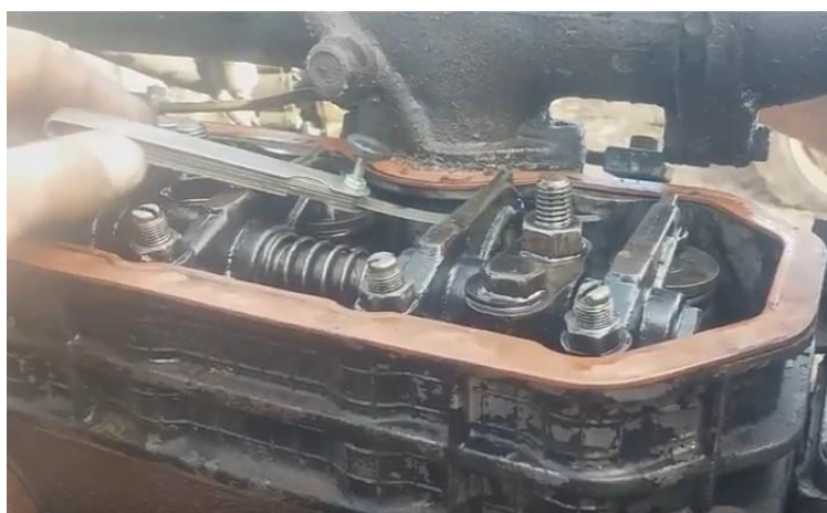
Рисунок 3.4 – Налаштування клапанного механізму двигуна
