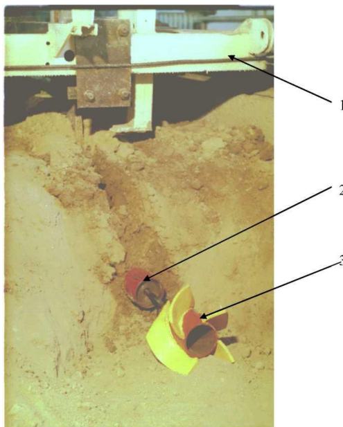
Рис.3.4. Процес входження дренера і самообертової фрези в цілик ґрунту: 1 - тензометричний візок; 2 - дронер; 3 - самообертова фреза
