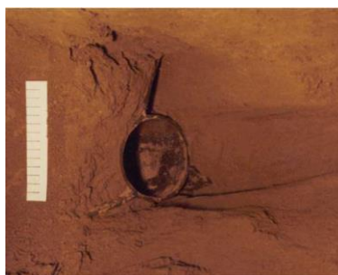
Рис. 3.2. Слід самообертювої фрези в цілику ґрунту (ґрунт, що був розпушений - видалено)
