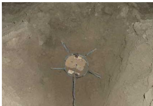
Рис.3.1. Самообертюва фреза з встановленим кінцевим вимикачем Дослідами встановлено зв'язок між кількістю ґрунторуйнівних елементів і процесом руйнування ґрунту фрезою.
