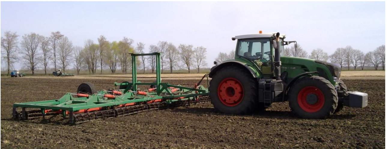
Рис. 2.10. Культиватор КВАНТ–12 у зчепленні з трактором Fendt 936 Vario
