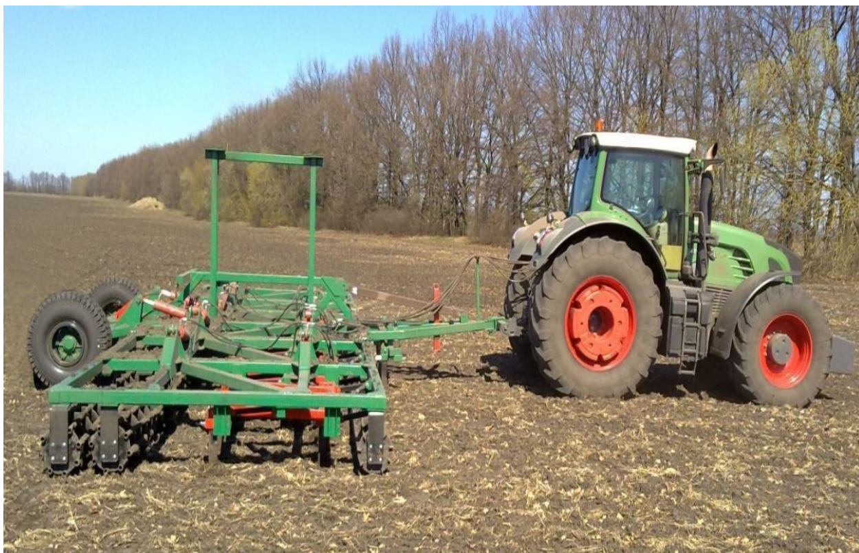
Рис. 2.12. Культиватор КВАНТ-12, підготовлений до експлуатаційних випробувань із застосуванням виготовлених і зміцнених робочих органів
