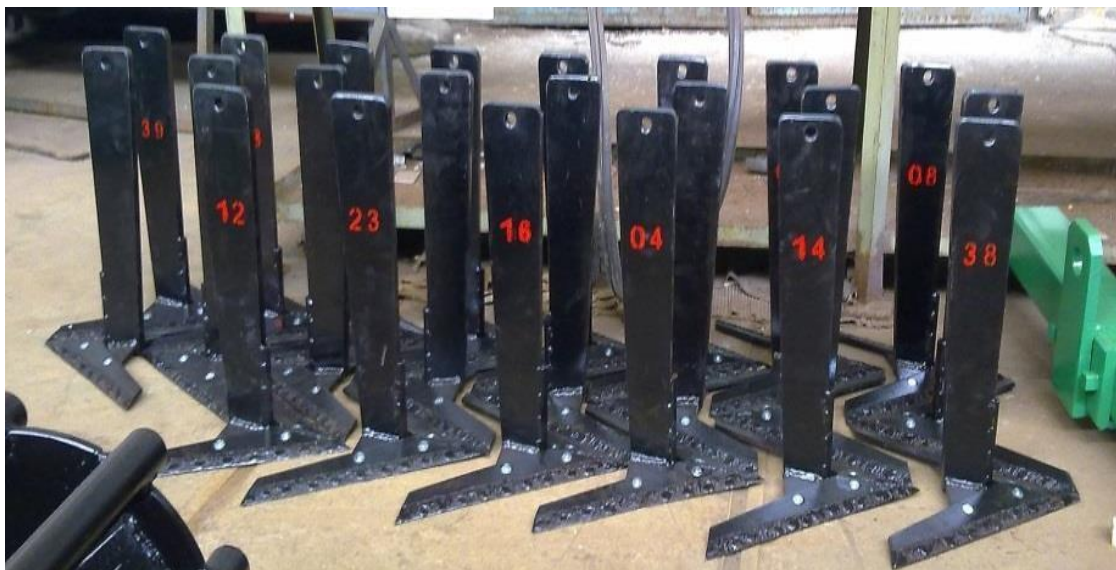
Рис. 2.11. Комплект виготовлених робочих органів та зміцнених стрілочастих лап для культиватора КВАНТ-12
