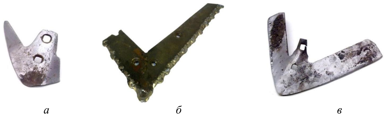
Рис.2.7. Приклади деформацій і пошкоджень культиваторних лап:
