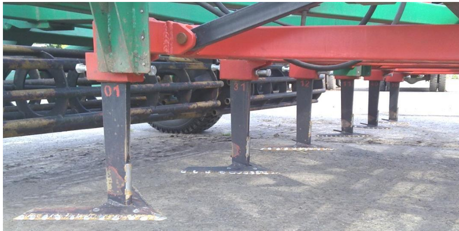
Рис. 2.13. Зовнішній стан робочих органів культиватора КВАНТ-12 після відпрацювання площі 55 га на один лаповий елемент
