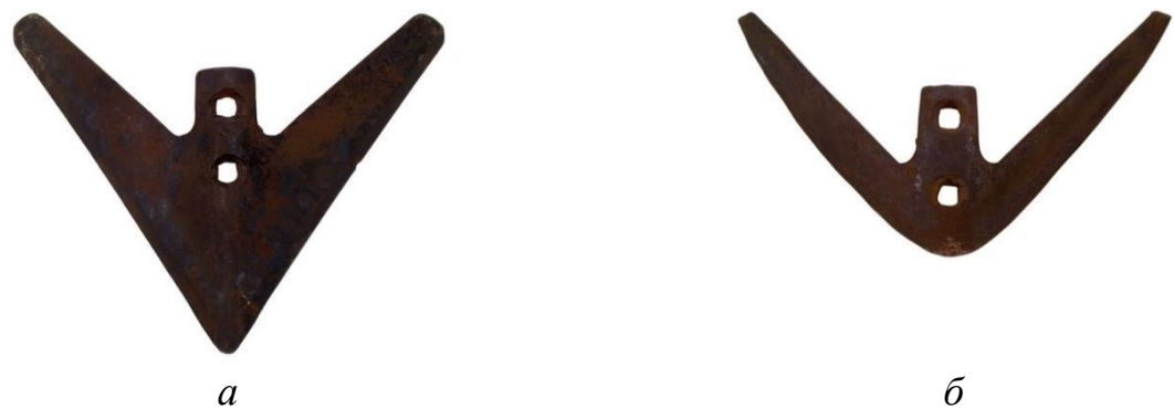
Рис. 1.8. Порівняльний вигляд нової (а) та зношеної (б) культиваторної лапи КПС (ширина 330 мм) після експлуатації на чорноземних ґрунтах
