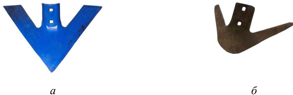
Рис. 1.5. Порівняльний вигляд нової (а) та зношеної (б) культиваторної лапи КПЕ-410 після експлуатації на піщаних ґрунтах
