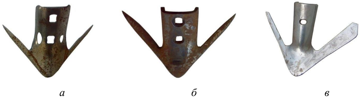
Рис. 2.9. Гранично зношені робочі органи з дефектами по ширині, товщині та захвату
