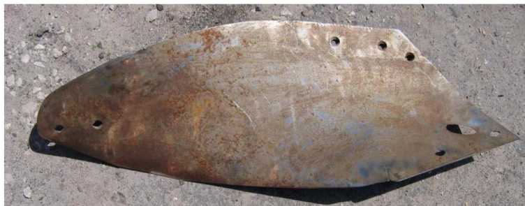
Рисунок 1.2 – Зношення площини відвалу плуга Gregoire Besson
