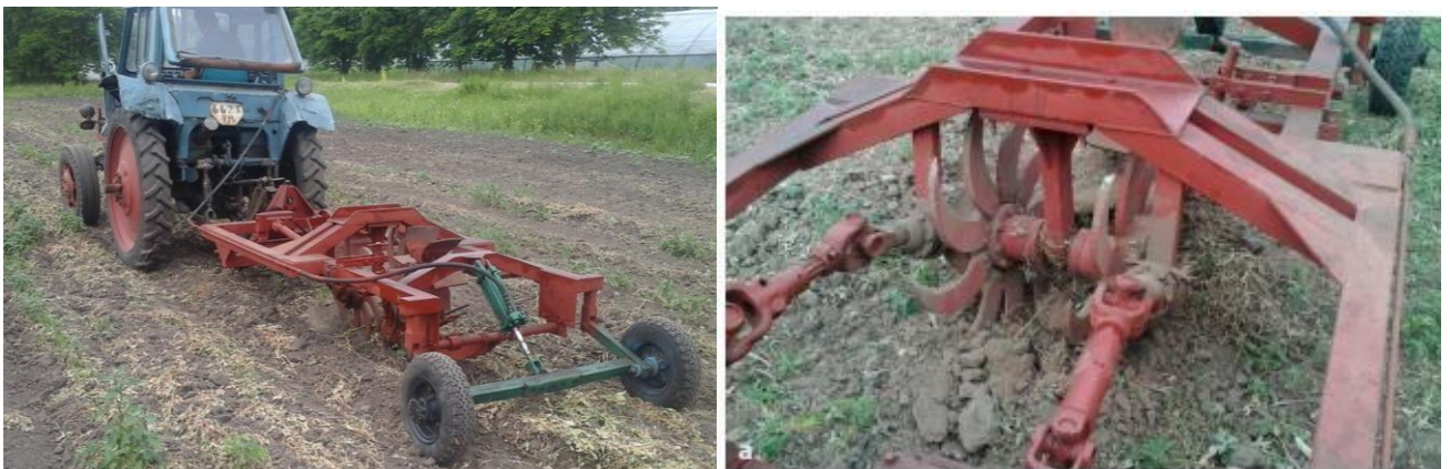
Рисунок 2.20 – Проведення експериментальних досліджень установки з експериментальними робочими органами в агрегаті з трактором МТЗ-80
