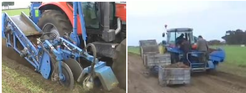
Рисунок 4.4 – Машина іноземного зразка з дисковими деблокаторами для викопування столових коренеплодів призначена для роботи на легких ґрунтах
