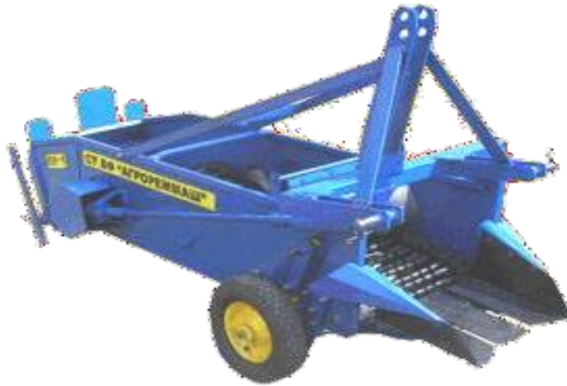
Рисунок 1.10 – Загальний вигляд копалки навісної КН-1
