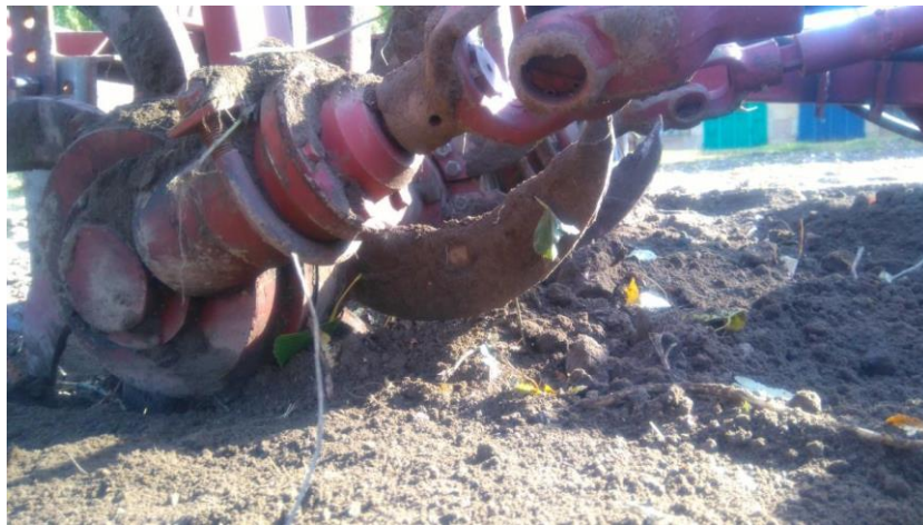
Рисунок 2.25 – Фото зубчатого деблокувального робочого органа в роботі Після процесу викопування проведено підрахунок та заміри столових коренеплодів (рис. 2.26).
