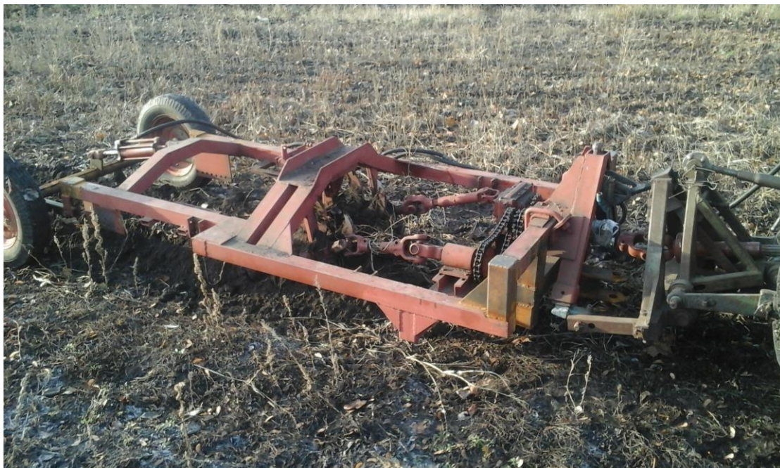
Рисунок 4.1 – Експериментальна установка для викопування довгоплідних столових коренеплодів
