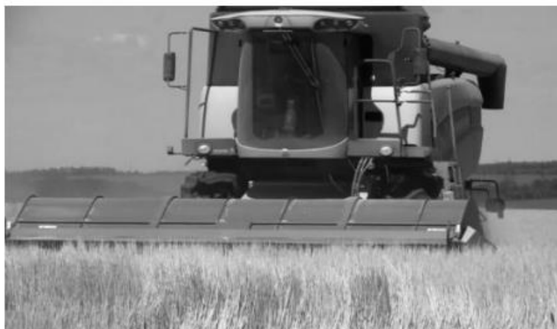
Рисунок 4.2 - Зернозбиральний комбайн з експериментальною жниваркою
