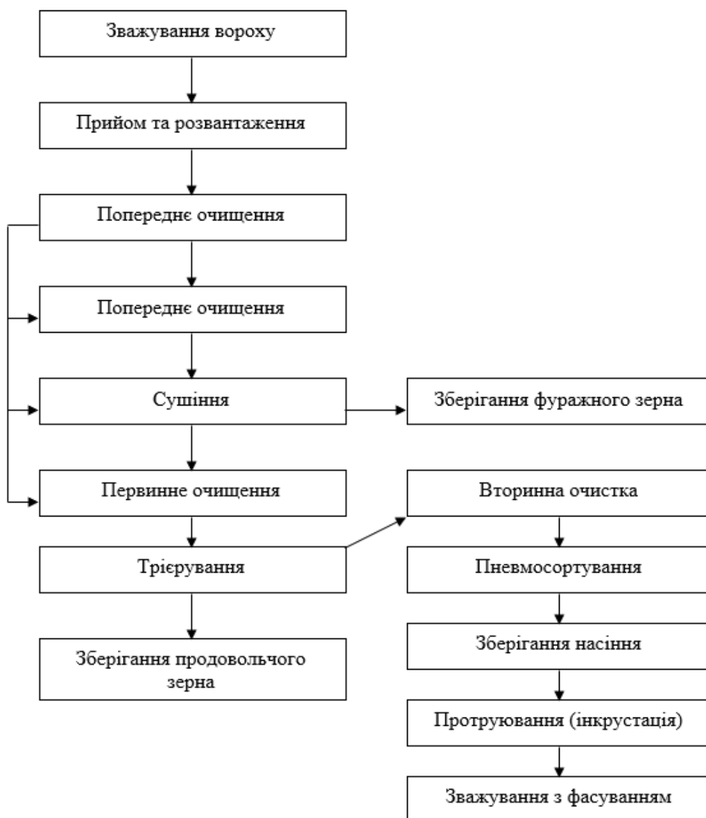
Рисунок 1.1 – Схема технологічного процесу післязбиральної обробки насіння зернових культур, продовольчого та фуражного зерна
