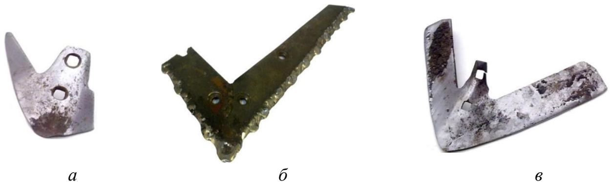
а – відлом крила культиваторної лапи КПС-270; б – відлом крила в місці кріплення лапи культиватора КВАНТ-12; в – протирання місця кріплення відновленої культиваторної лапи КПС-330
