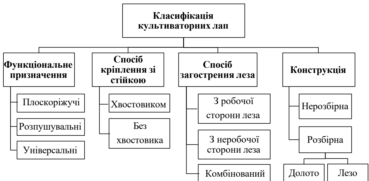
Рисунок 1.3 – Класифікація культиваторних лап
