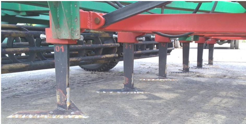
Рисунок 2.13 – Загальний вигляд лап культиватора КВАНТ-12 після наробітку 55 га на один робочий орган
