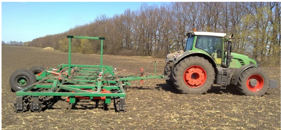
Рисунок 2.12 – Культиватор КВАНТ-12, укомплектований виготовленими і зміцненими робочими органами для проведення випробувань в польових умовах
