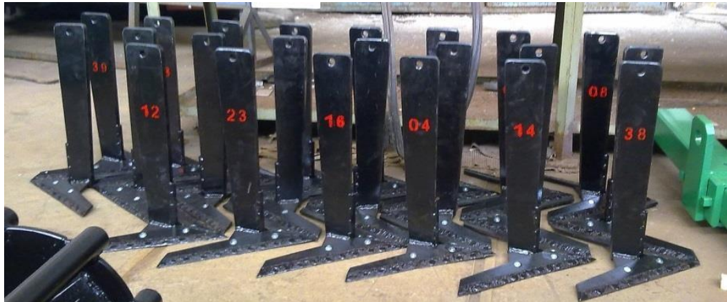
Рисунок 2.11 – Загальний вигляд комплекту виготовлених робочих органів і зміцнених стрічастих лап до культиватора КВАНТ-12
