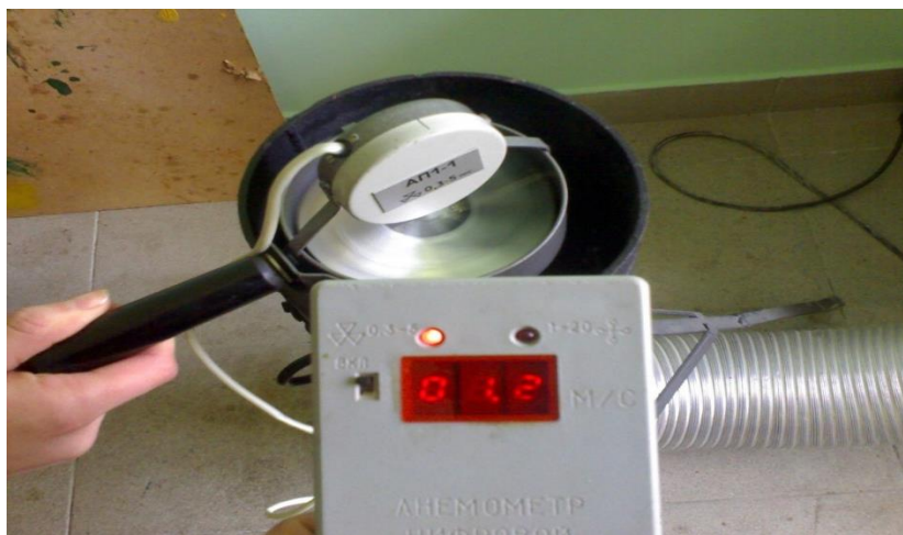
Рисунок 3.3 – Визначення швидкості руху сушильного агента в дослідній установці за допомогою анемометра АП-І
