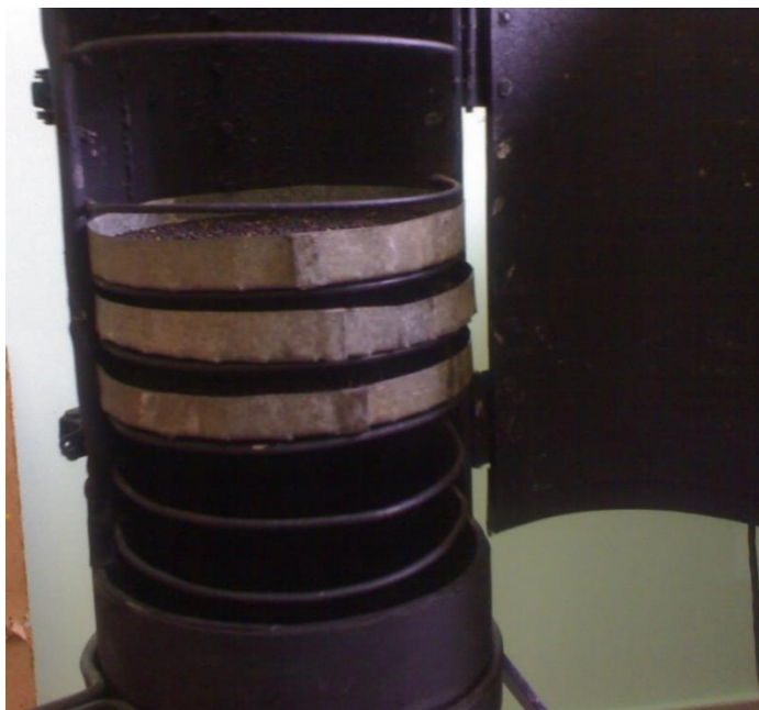
Рисунок 3.1 – Сушильна камера дослідної установки
