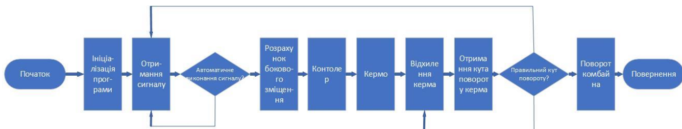
Рисунок 3.1. Схема керування системою автоматичного вирівнювання
