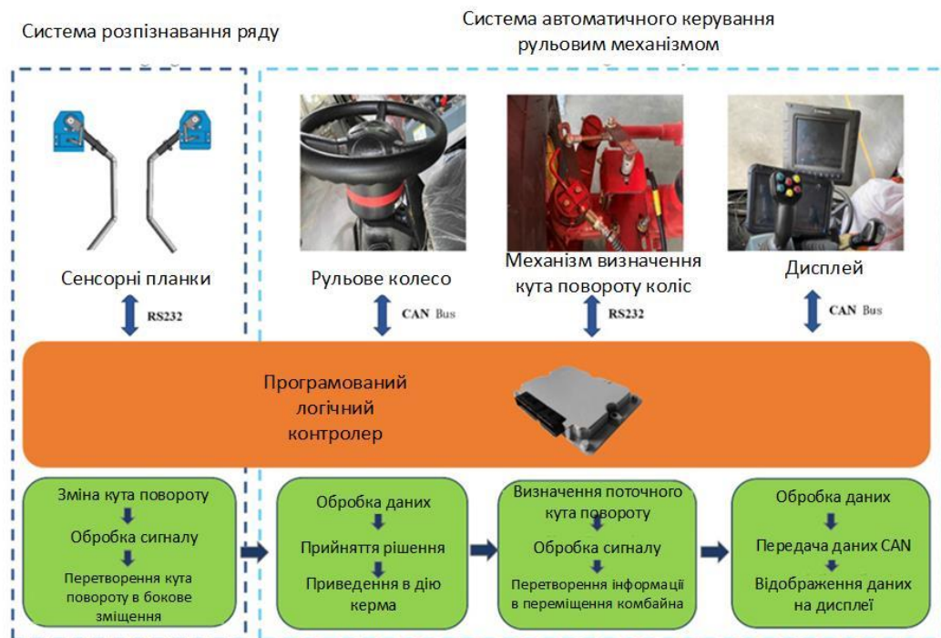
Рисунок 2.2. Принцип роботи системи автоматичного вирівнювання рядків кукурудзозбирального комбайну.
