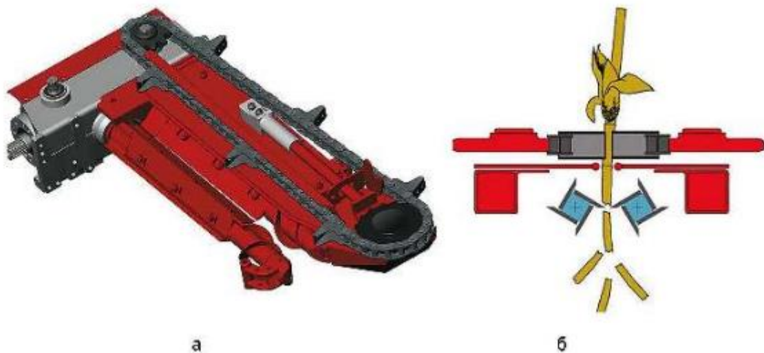
Рисунок 1.1. Стеблеподрібнювальний апарат а - загальний вигляд (знизу), б - технологічна схема роботи апарата, що відділяє качани.
