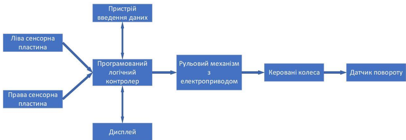
Рисунок 2.1. Структурна схема системи автоматичного керування руху комбайна по рядкам.
