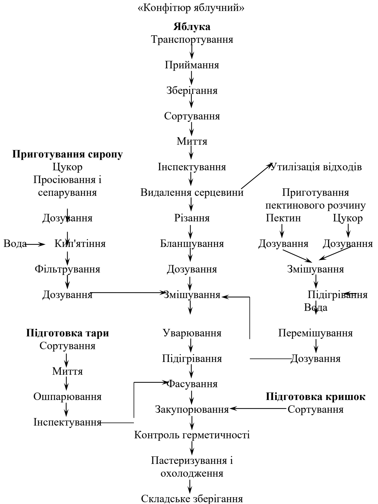
Рис. 2.2 Технологічна схема виробництва консервів «Конфітюр яблучний»
