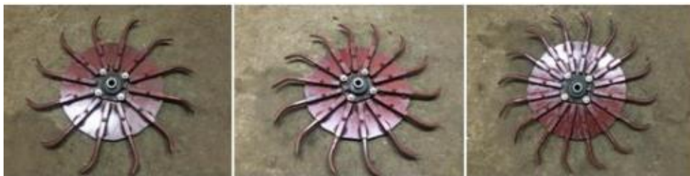
Рисунок 3.1 – Зовнішній вигляд експериментальних ротаційних робочих органів: n=12 шт; n=14 шт; n=16 шт; Діаметр кожного диска D = 500, 525, 550 мм.
