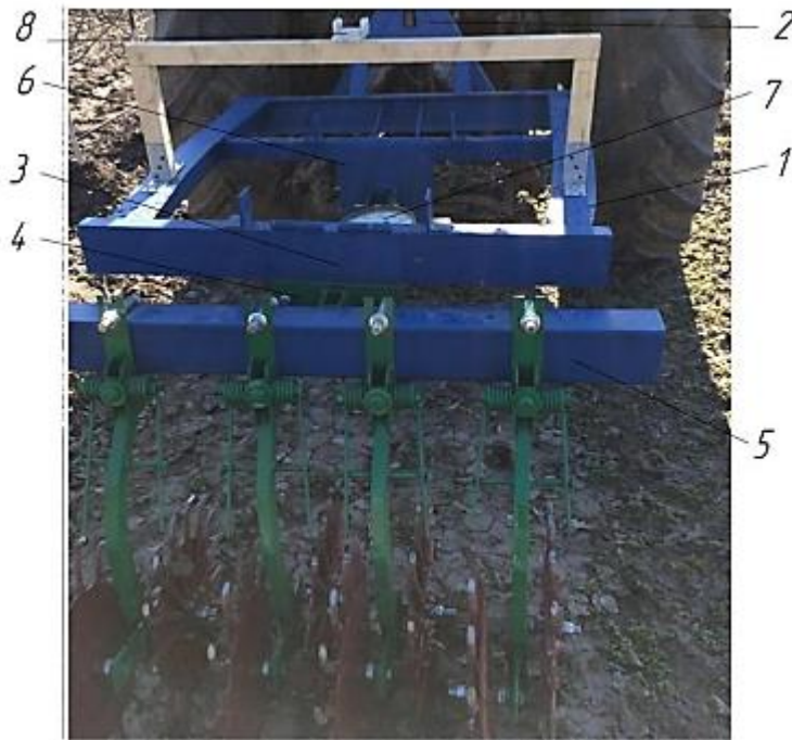
Рисунок 3.5 – Експериментальна установка визначення енергетичних показників секції ротаційної борони; 1 – динамометрична рамка, 2 – гідронавіска трактора, 3 – шарнірна ланка, 4 – кронштейн, 5 – секція борони, 6 – кронштейн, 7 – динамометр, 8 – відеокамера з прискореною зйомкою.
