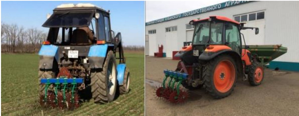
Рисунок 3.3 – Експериментальне встановлення для проведення досліджень: а) загальний вигляд експериментальної установки; б) МТА для боронування посівів з одночасним підживленням.
