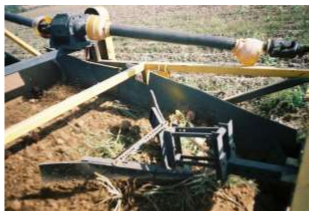
Рис. 2.13. Загальний вигляд пруткових барабанів
