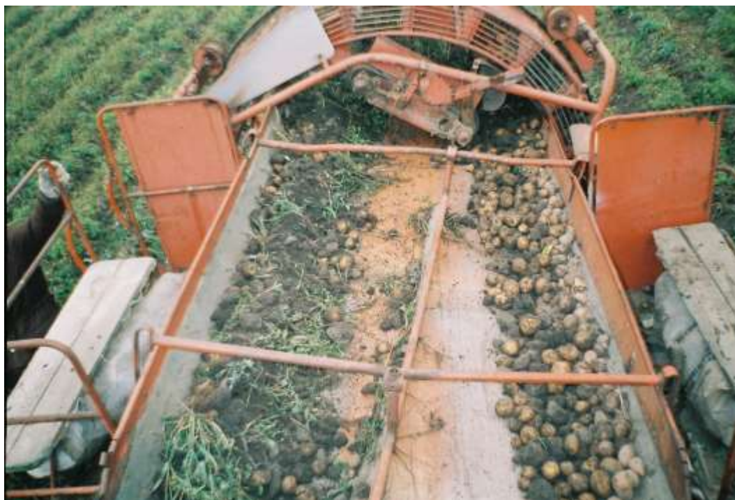
Рис. 2.6. Відбір проб з перебирального столу експериментальної установки
