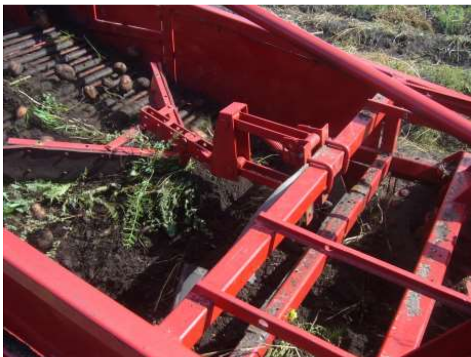
Рис. 2.10. Загальний вигляд розподільника вороху картоплекопача КРК-2 під час роботи
