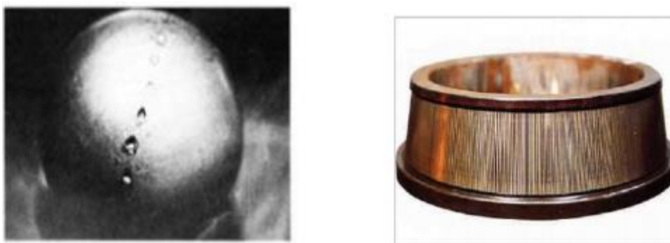
Рисунок 1.14 – Електроерозійний пітінг доріжок кочення: кратери на кульках, спричинені проходженням сильного струму.
