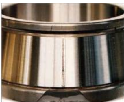
Рисунок 1.18 – Розколювання елементів підшипника (тріщини та розколи).
