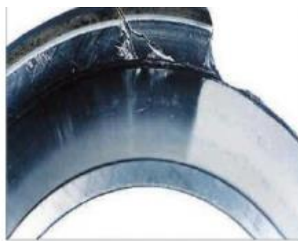
Рисунок 1.18 – Розколювання елементів підшипника (тріщини та розколи).
