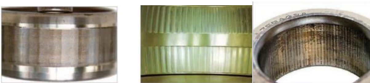
Рисунок 1.9 – Абразивне зношування: пошкодження доріжки кочення.
