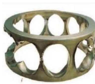
Рисунок 1.18 – Розколювання елементів підшипника (тріщини та розколи).
