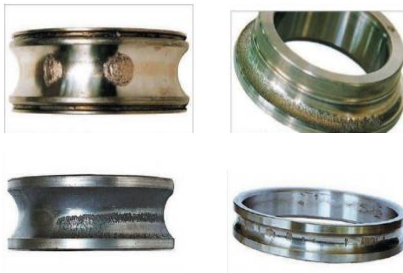
Рисунок 1.7 – Втомне руйнування доріжки кочення.
