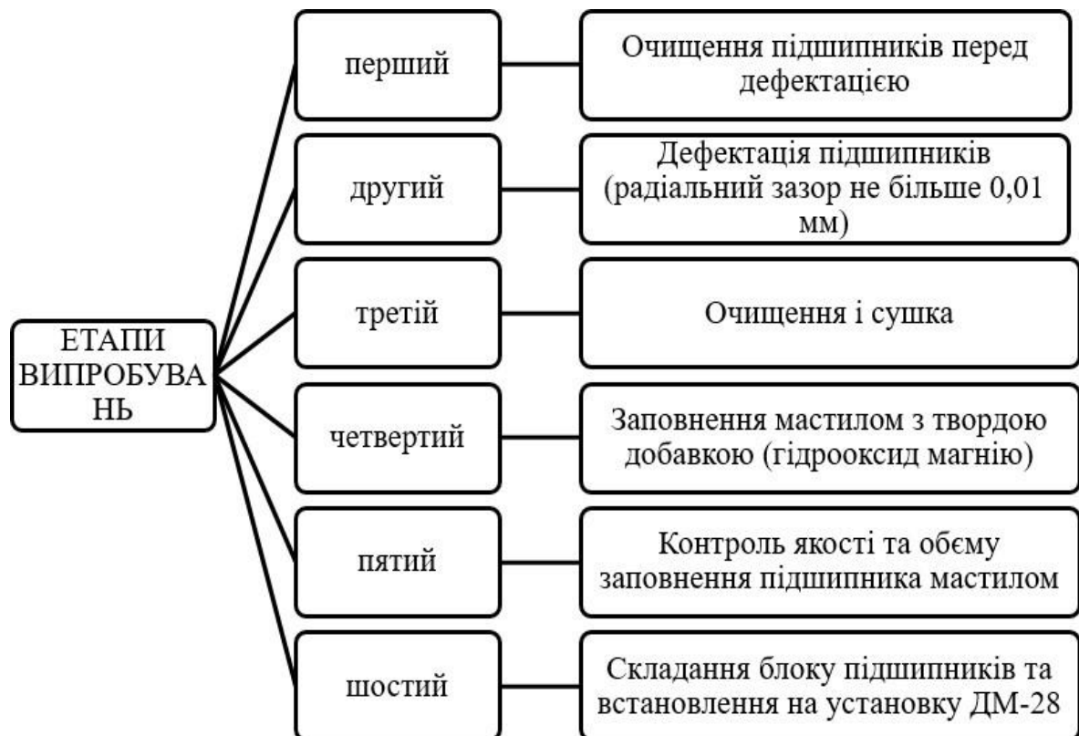
Рисунок 3.7 – Послідовність підготовки зразків (підшипників) до випробувань.
