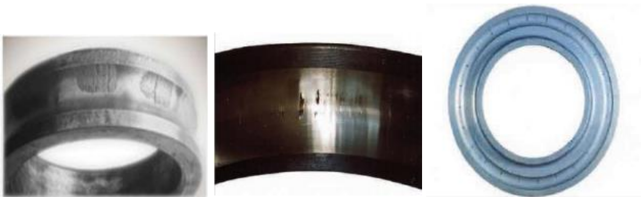
Рисунок 1.13 –Неправильне бринелювання: відбитки на доріжці кочення внаслідок передавання монтажного зусилля через тіла кочення.
