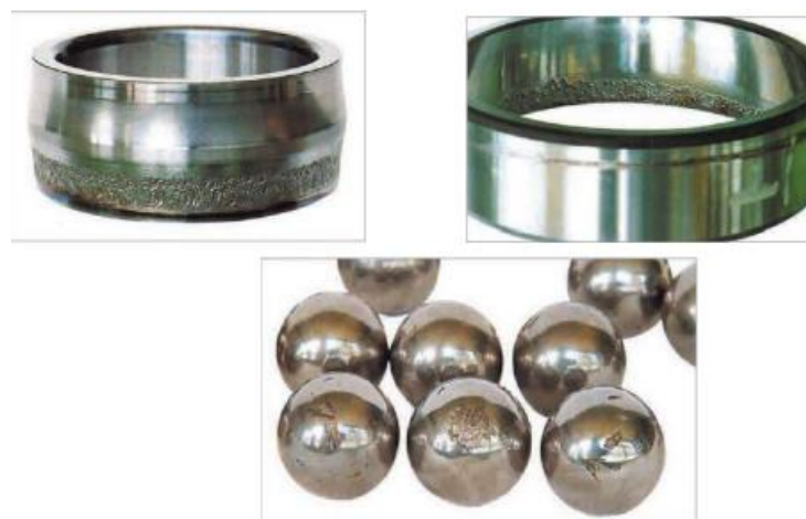
Рисунок 1.7 – Втомне руйнування доріжки кочення.
