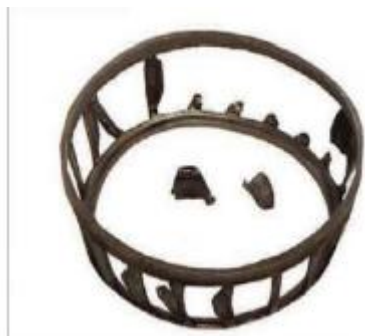
Рисунок 1.18 – Розколювання елементів підшипника (тріщини та розколи).
