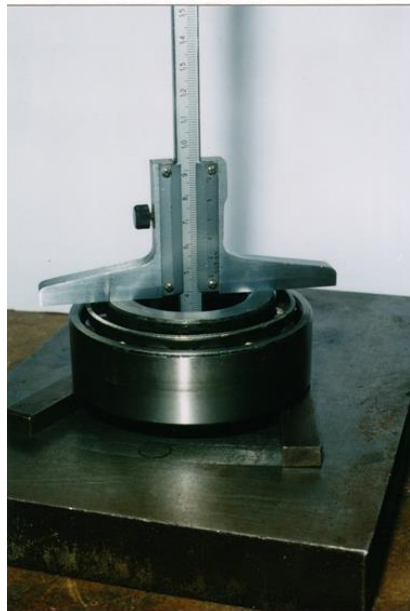
Рисунок 3.3 – Контроль осьового зазору підшипника.
