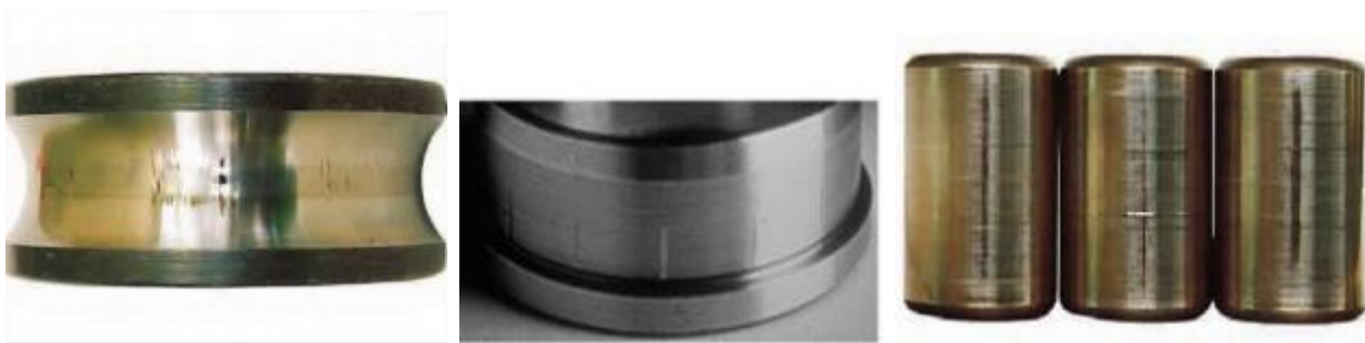
Рисунок 1.12 – Відбитки (бринелювання) на доріжках кочення.
