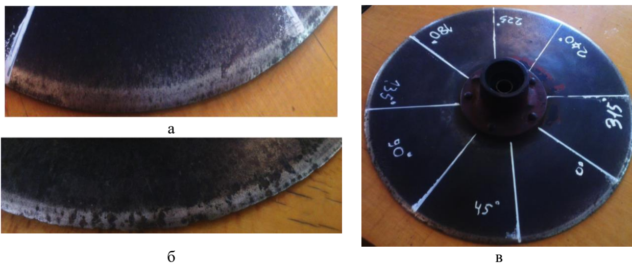
Рисунок 2.1 Виміряний диск та його знос
