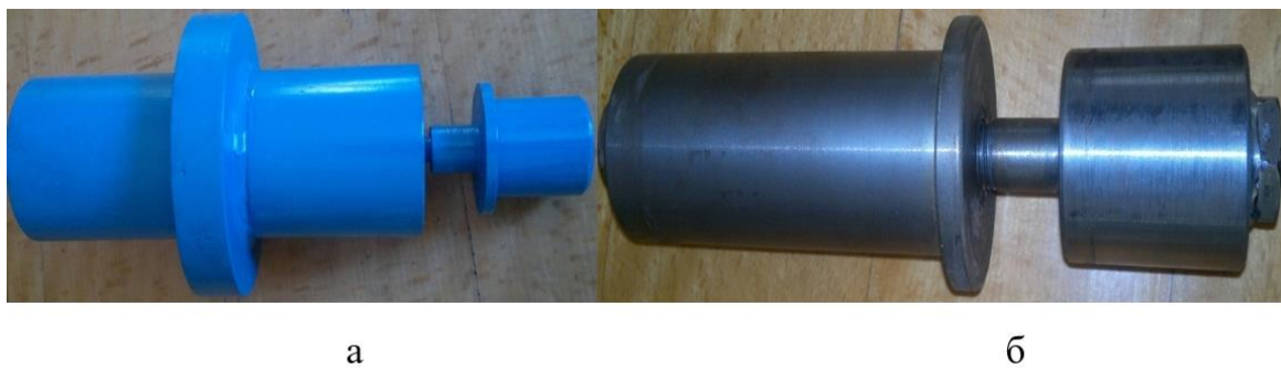
Рис. 3.3 Пристрій для закріплення дисків сошників: а - досвідчений екземпляр, б - основний екземпляр
