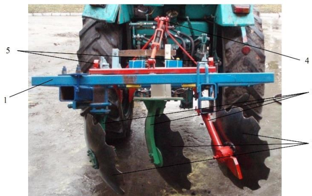
Рисунок 3.1 – Загальний вигляд експериментальної установки, споряджена суміжними робочими органами: 1 – рама, 2 – стійки, 3 – сферичні диски, 4 – навісний елемент, 5 – підшипникові вузли
