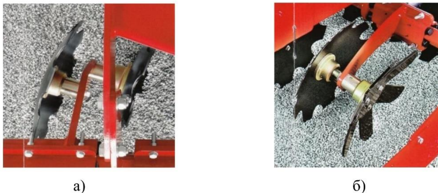
Рисунок 1.5 – Вигляд здвоєних рівновеликих дисків у двох виконаннях: а – різних діаметрів; б) – різного виконання
