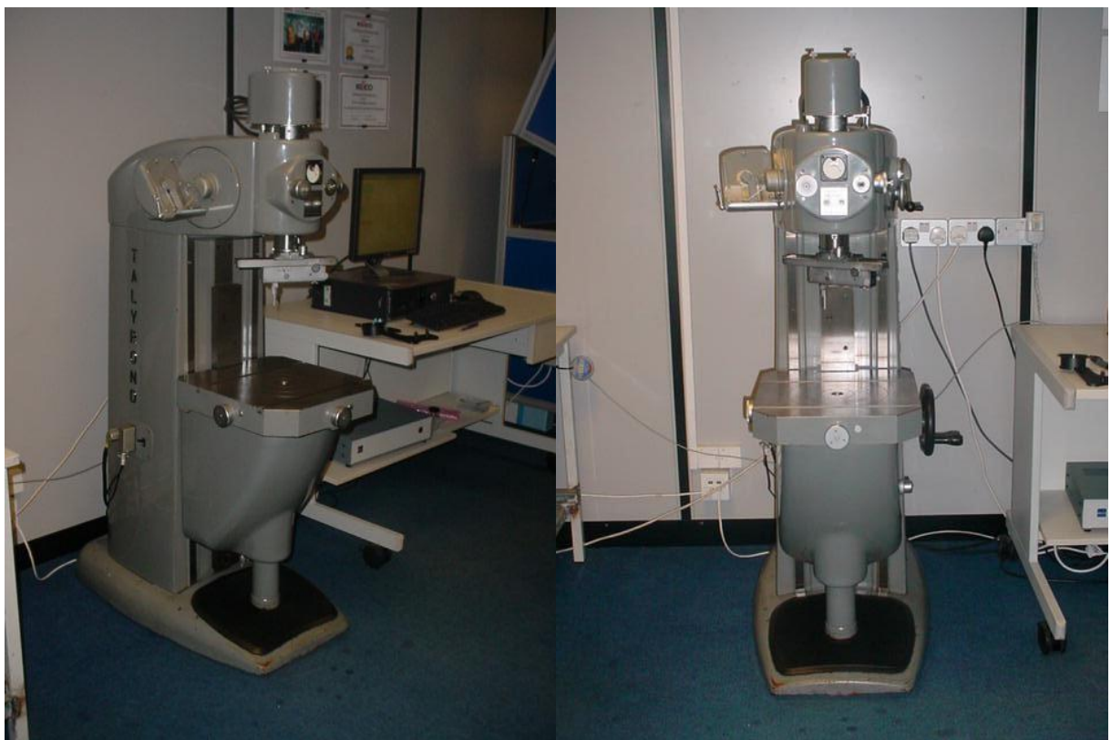
Рисунок 3.1 – Профілограф «Talyrond» для дослідження мікро геометрії плунжерних пар
