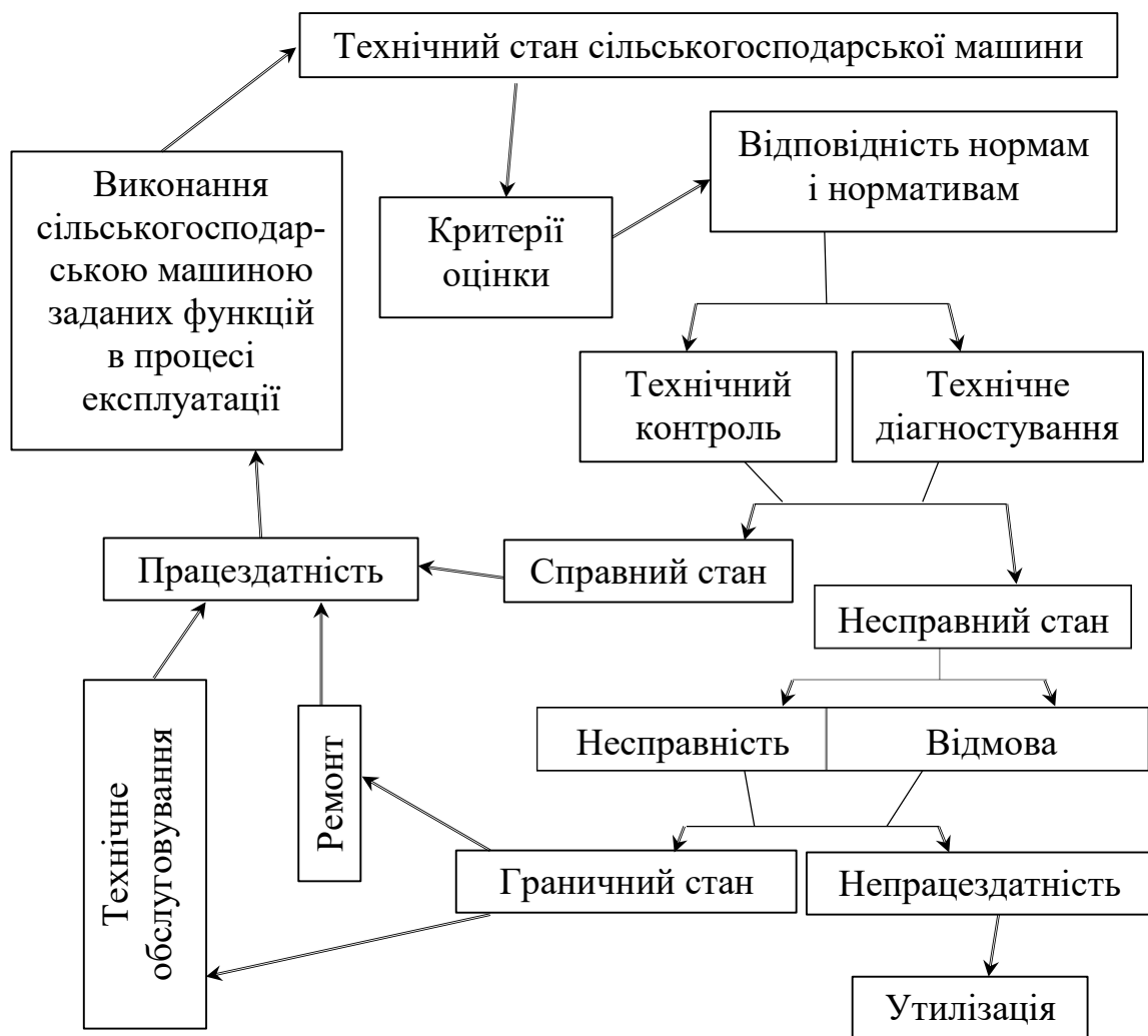
Рис. 1.1. Узагальнена схема станів і подій сільськогосподарської машини в процесі експлуатації.
