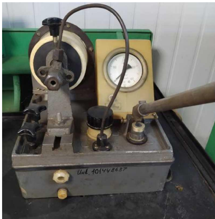
Рис. 3.6. Налаштування гідроаккумулятора експериментальної установки на приладі КИ 15706
