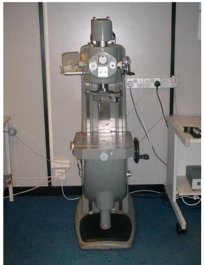
Рис.3.1. Профілограф «Talyrond» для дослідження мікро геометрії плунжерних пар
