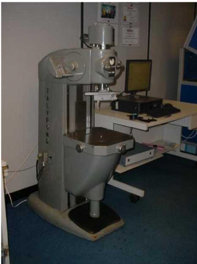
Рис.3.1. Профілограф «Talyrond» для дослідження мікро геометрії плунжерних пар
