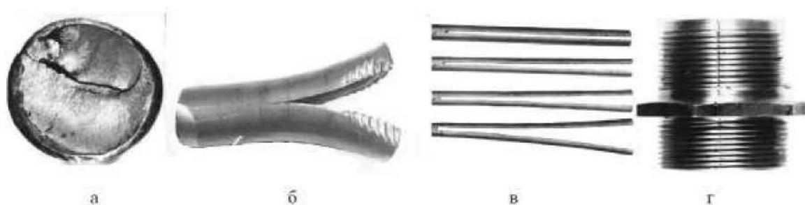
Рисунок 2.4.- Дефекти виробів з каліброваного металу: а – розкриття кінця прутка при виході з матриці; б – тріщина на кінці заготовки після холодного деформування; в – спотворення форми заготовки при фрезеруванні поздовжнього паза; г – тріщина на поверхні деталі після обробки різанням
