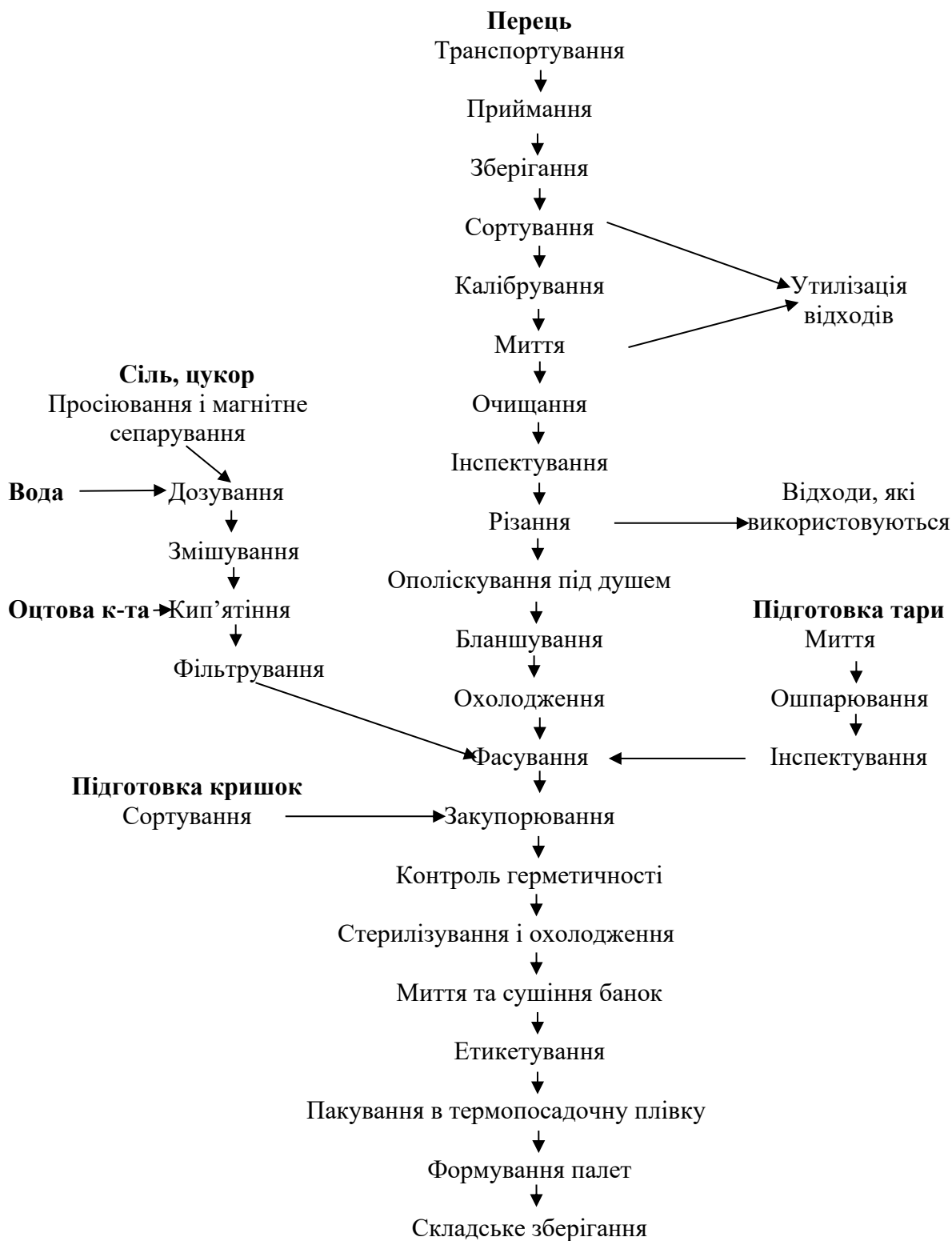
Рис. 2.1. Технологічна схема виробництва консервів «Перець маринований різаний»
