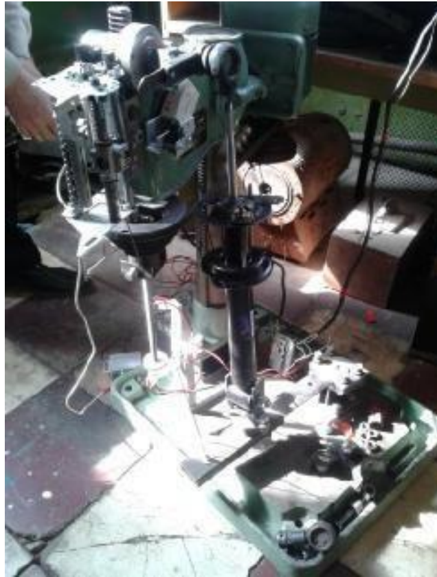
Рисунок 3.6 – Експериментальна установка самостійного виготовлення для дослідження амортизаторів по зусиллю стиску й відбою
