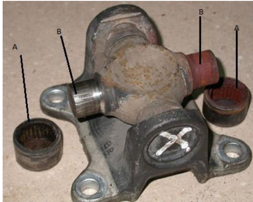
Рисунок 3.17 – Зовнішній вигляд зношених деталей підшипникового вузла хрестовини
