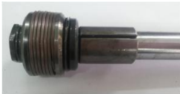
Рисунок 3.5 – Поршень у зборі з ущільнювальним обмідненим пружинним вкладишем
