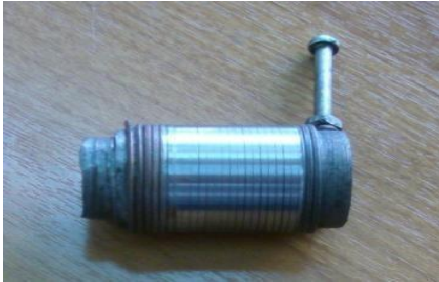
Рисунок 3.4 – Пружинний вкладиш на оправленні після круглого шліфування
