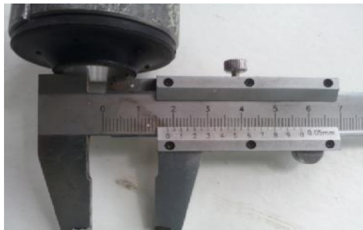
Рисунок 3.9 – Розточений внутрішній діаметр алюмінієвої втулки сайленблока
