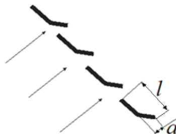
Рисунок 2.7 – Схема подачі повітряного потоку для псевдозрідження
