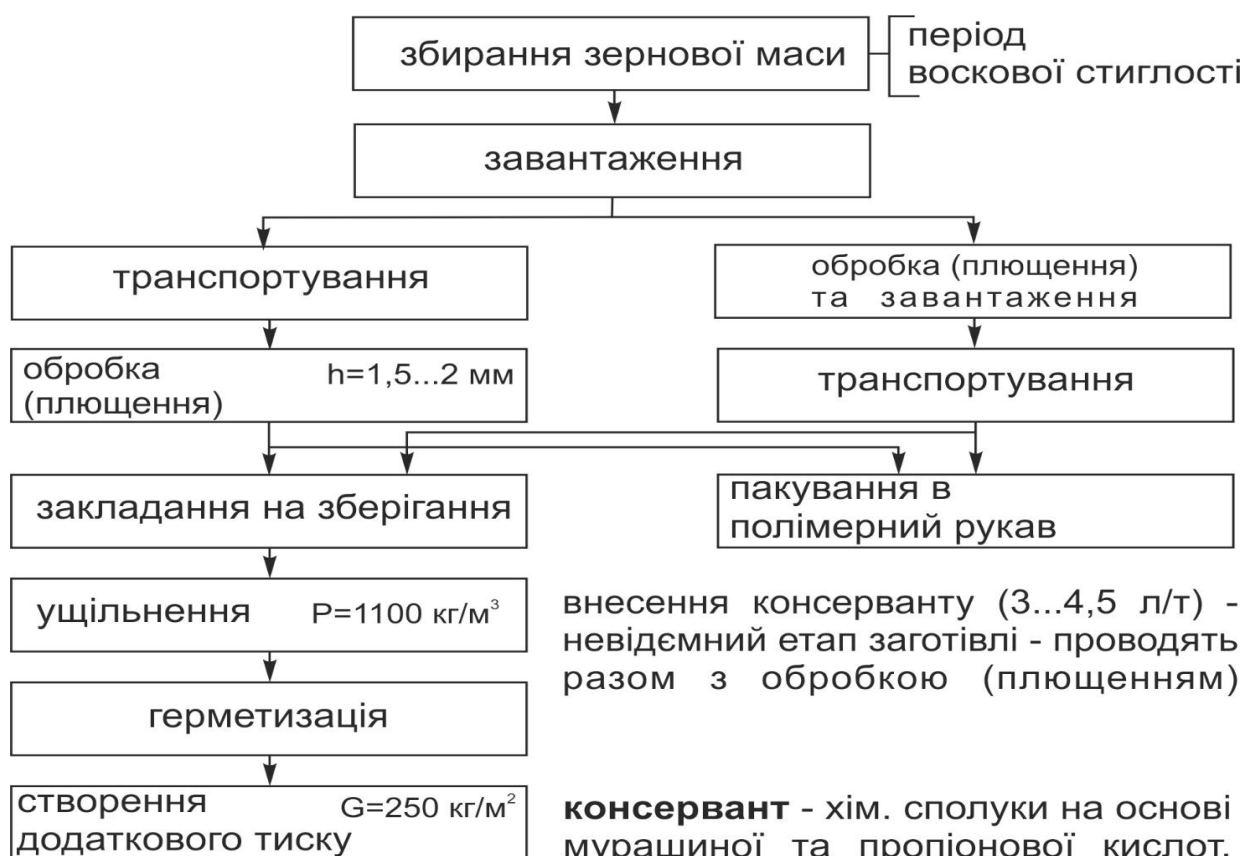
Рис. 1.2. Технологічна модель заготівлі сінажу із застосуванням диференційованих підходів
