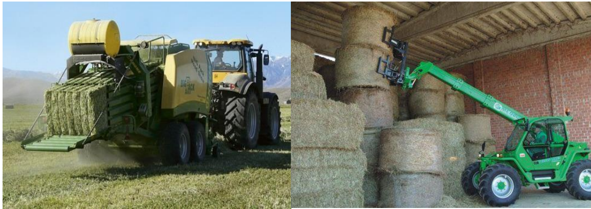
Рис. 1.5. Тюкувальний прес високої щільності моделі KRONE BiG Pack 1290 HDP (1), а також багатофункціональний телескопічний навантажувач виробництва Merlo (2)
