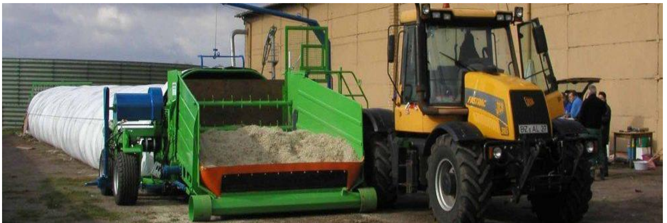
Рис. 1.5. Типовий вигляд пакувальної машини AG-BAG RT 8000
