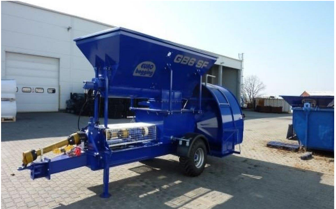
Рис. 1.6. Оглядове зображення агрегату для плющення та пакування зволоженого зернофуражу моделі «Grinder bagger» GB 6
