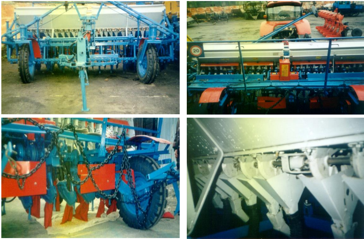
Рисунок 5.3 – Загальний вид сівалки ЗС-3,6, обладнаної внутрішньоребристими висівними апаратами запропонованої конструкції
