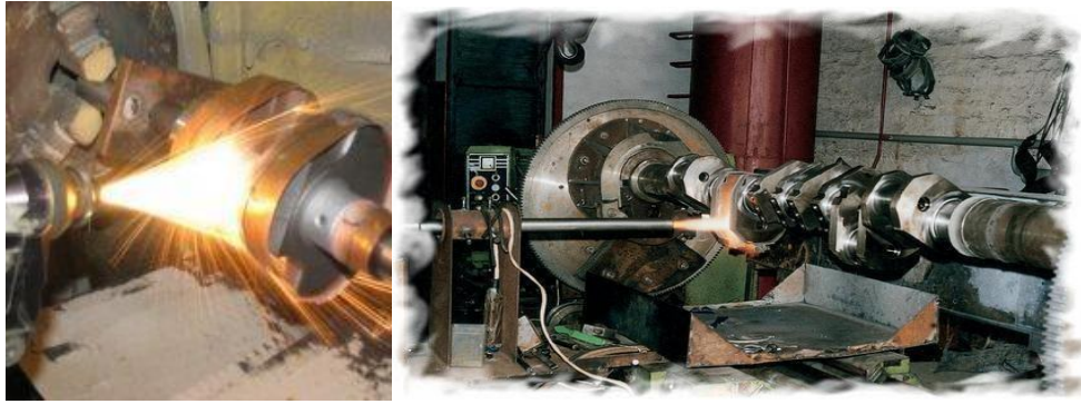
Рисунок 3.1 – Комплекс обладнання для електроіскрового наплавлення циліндричних поверхонь.
