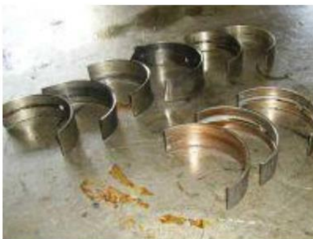
Рисунок 2.8 – Вкладиші крайніх опор (знос незначний)
