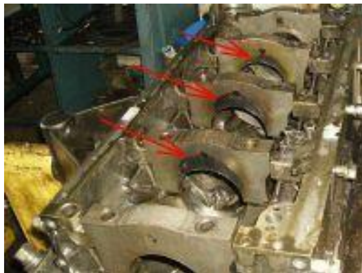
Рисунок 2.5 – Виробіток корінних опор (сліди кольорів побіглості)
