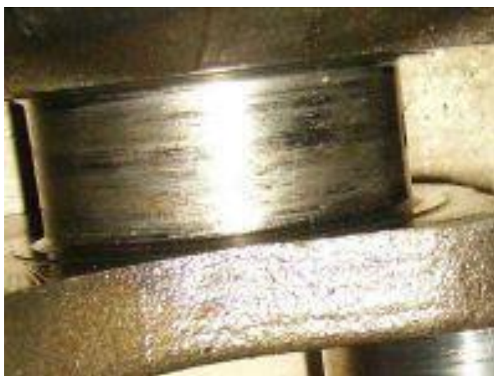
Рисунок 2.13 – Кольори побіжності на корінній шийці свідчать про перегрів та
