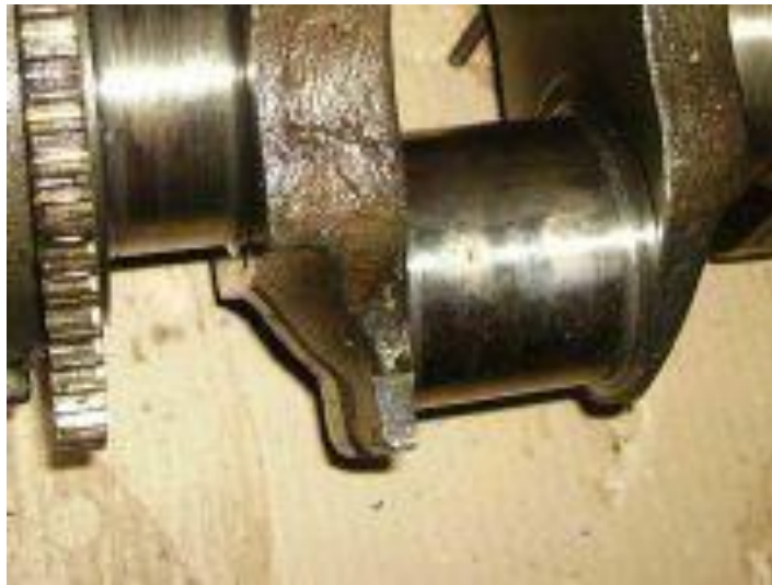
Рисунок 2.10 – Четверта шатунна шийка колінчастого вала
