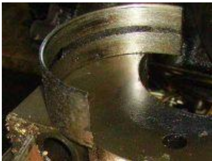
Рисунок 2.7 – Виробітка корінних вкладишів (риски, подряпини та обірвані вусики)
