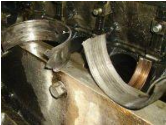
Рисунок 2.6 – Виробітка корінних вкладишів (розплескані кінці)
