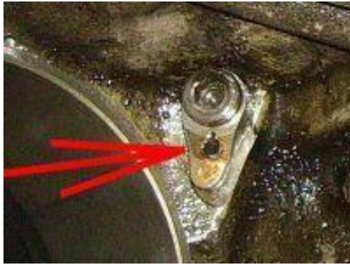
Рисунок 2.4 – Поломка масляної трубки
