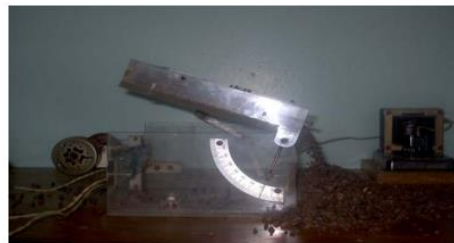
Рисунок 2.16 - Гірка академіка В.А. Желігівського для визначення кутів внутрішнього та зовнішнього тертя
