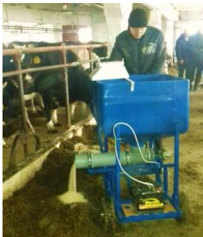
Рисунок 3.11 – Процес дозованої роздачі комбікормів спіралью-гвинтовим дозатором.
