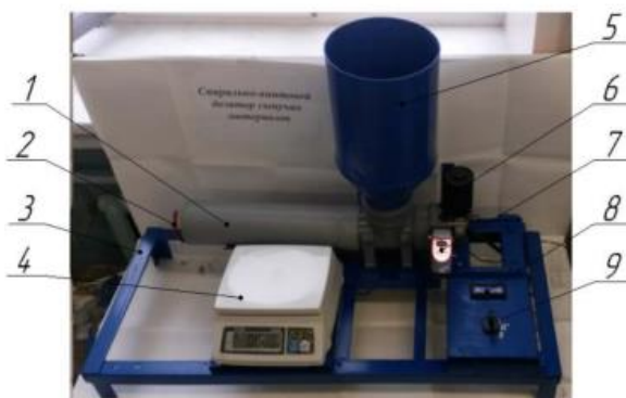
Рисунок 2.18 – Загальний вигляд експериментальної лабораторної установки: 1 - циліндричний корпус, 2 - спіраль, 3 - рама, 4 - ваги CAS SW-05, 5 - бункер із завантажувальною горловиною, 6 - моторедуктор 16.3730, 7 - тахометр SM8238, 8 - вимірювальний комплекс перемикач.
