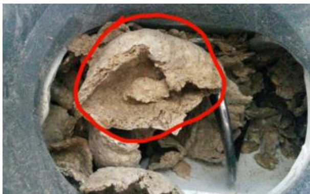
Рисунок 3.5 - Зависання екструдованого комбікорму між витками спіралі.
