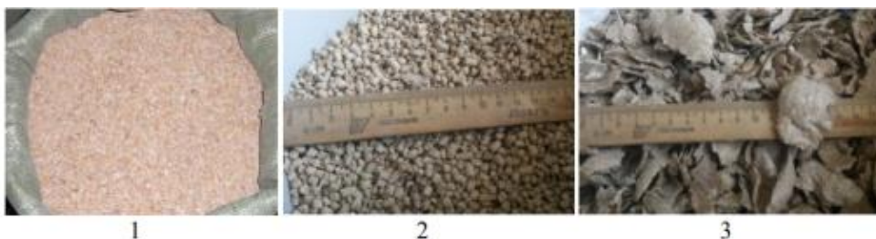
Рисунок 2.13 – Сухі концентровані корми, що використовуються при вивченні спірально-гвинтового дозатора: 1 – розсипні висівки, 2 – гранульований комбікорм, 3 – екструдований комбікорм.
