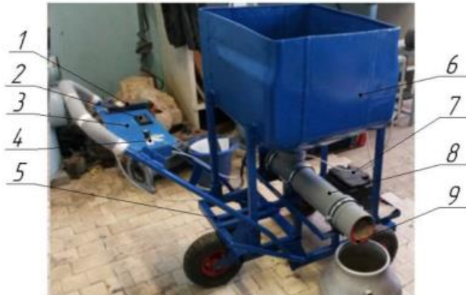
Рисунок 2.20 – Мобільний роздатчик кормів зі спіралью-гвинтовим дозатором: 1 – лічильник обертів SM8238, 2 – вимірювальний комплект MYLB-GT Power RC 130A, 3 – панель управління, 4 – перемикач режимів, 5 – ручний візок, 6 – бункер для концентрованого корму, 7 – акумулятор, 8 – циліндричний кожух, 9 спіраль.
