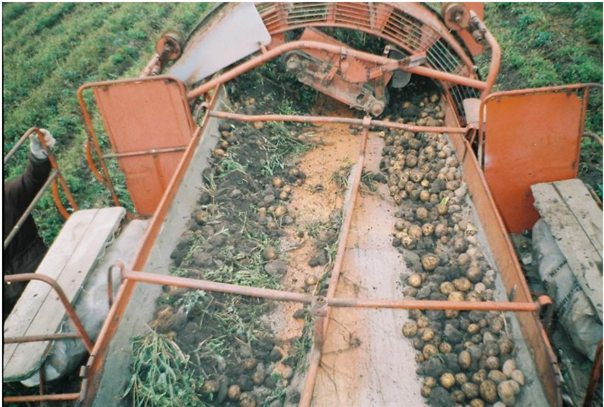
Рис. 2.6. Відбір зразків матеріалу з перебирального столу під час експериментальних випробувань установки
