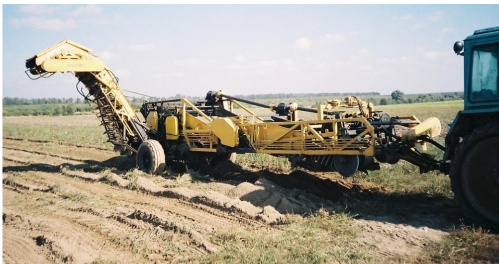
Рис. 2.12. Огляд конструкції картоплекопача-навантажувача моделі ККН-2
