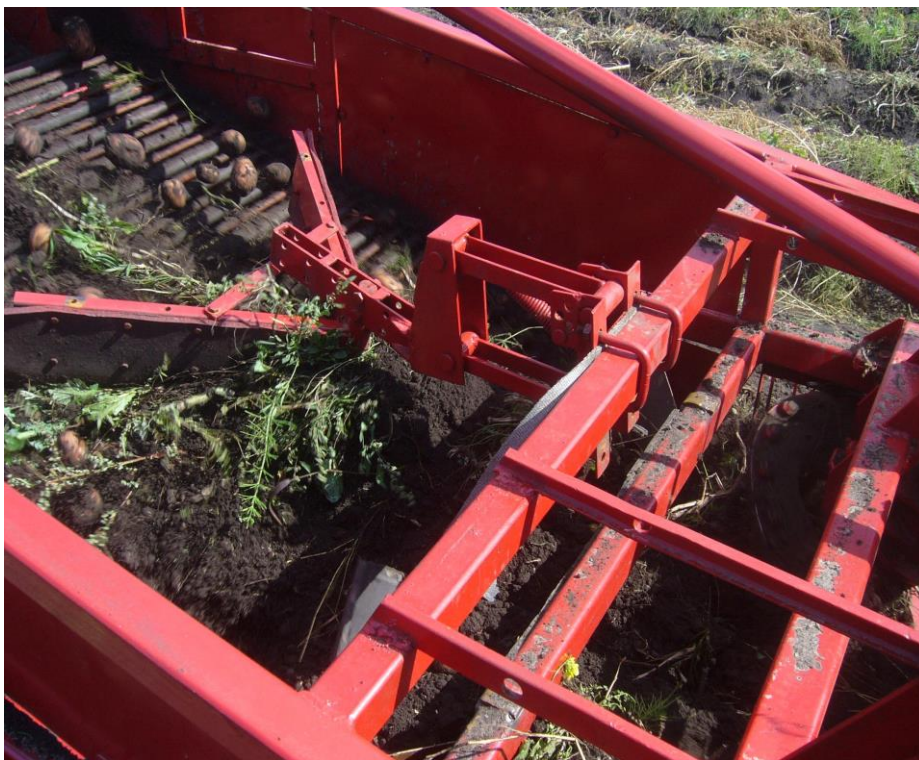
Рис. 2.10. Розподільник вороху картоплекопача КРК-2 під час експлуатації
