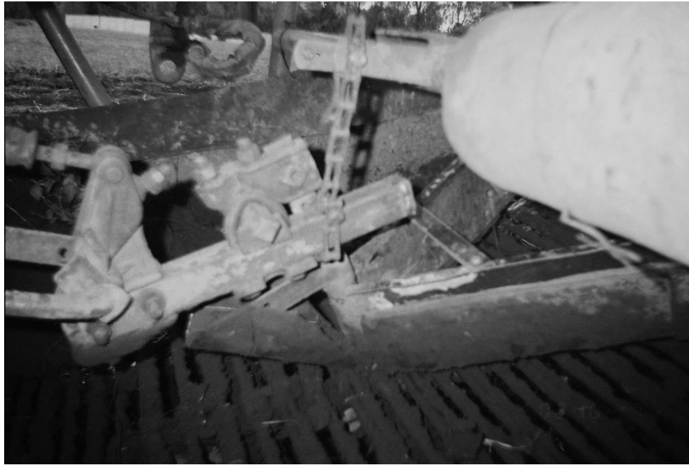
Рис. 2.4. Загальний вид розподільника, встановленого над сепаруючим транспортером
