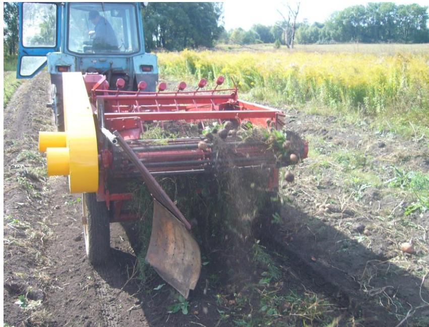
Рис. 2.9. Зображено картоплекопача КРК-2 в процесі:
