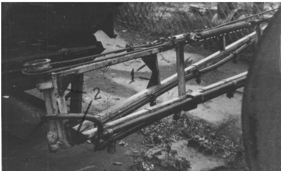
Рисунок 1.4 - Характерні поломки типових секцій штанг сільськогосподарських обприскувачів: 1 – крайня секція є підсилена косинцями; 2 – підсилення проміжної секції.
