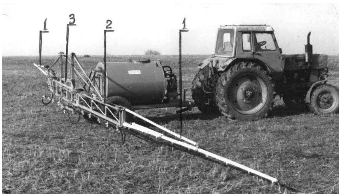
Рисунок 1.5 - Вдосконалена штанга причіпного обприскувача ОПШ-15: 1- функціонально-несучі крайні секції штанги з базальтопластику; 2 – проміжна секція; 3 – центральна секція.
