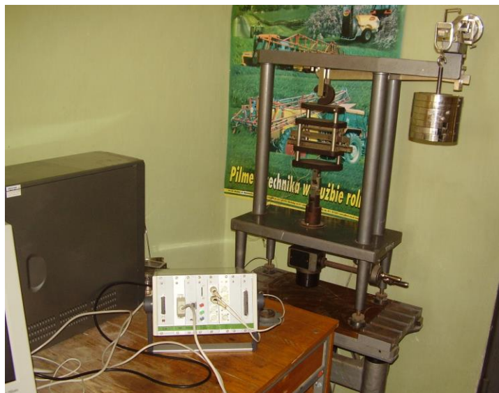
Рисунок 2.9 - Схема тарування тензометричних каналів реєструючої апаратури
