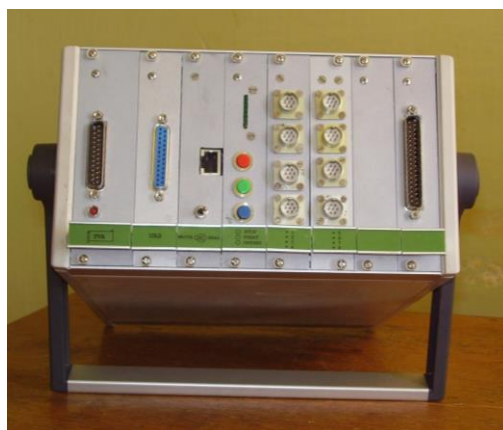
Рисунок 2.8 - Реєструючий блок вимірювальної системи
