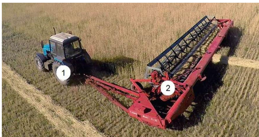
Рисунок 1.2 – Скошування та укладання хлібів у валок при роздільному способі збирання: 1 – трактор; 2 – валкова жатка.
