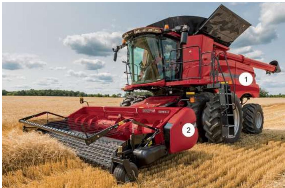
Рисунок 1.3 – Підбір та обмолот валків при роздільному способі збирання:
