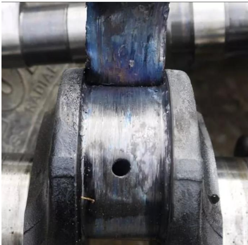
Рисунок 1.8 – Приварювання вкладиша до шийки внаслідок проворачування валу
