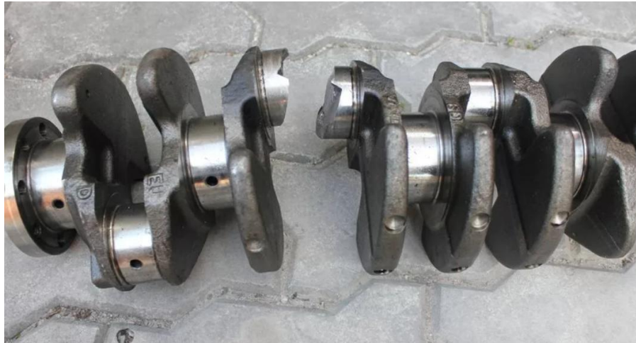
Рисунок 1.9 – Руйнування колінчатого валу
