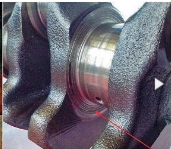
Задир упорної поверхні вала
