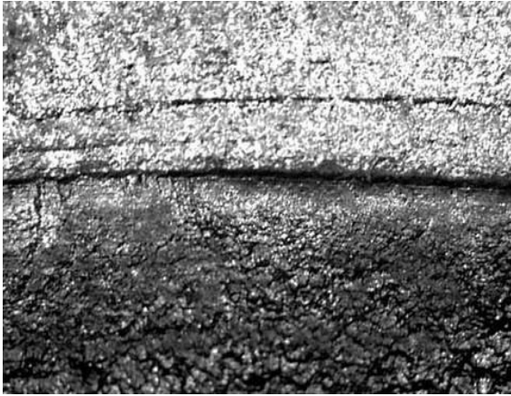
Рисунок 2.4 – Макроструктура зламу в щоці: перехід із зони розвитку втомленої тріщини в зону тендітного руйнування (50:1)
