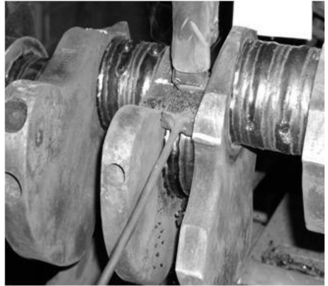
Рисунок 3.9 – Процес наплавлення корінної шийки колінчатого вала
