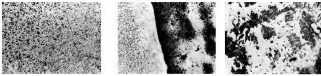
Рисунок 3.17 – Мікроструктура зразка, наплавленого дротом 08X20H9Г7Т (200:1): а – зона наплавлення; б – перехідна зона; в – зона термічного впливу
