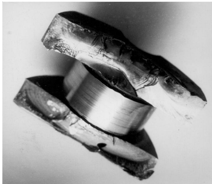
Рисунок 1.13 – Злам колінчатого вала двигуна «RABA-MAN» по щоках від дії нормальних напружень
