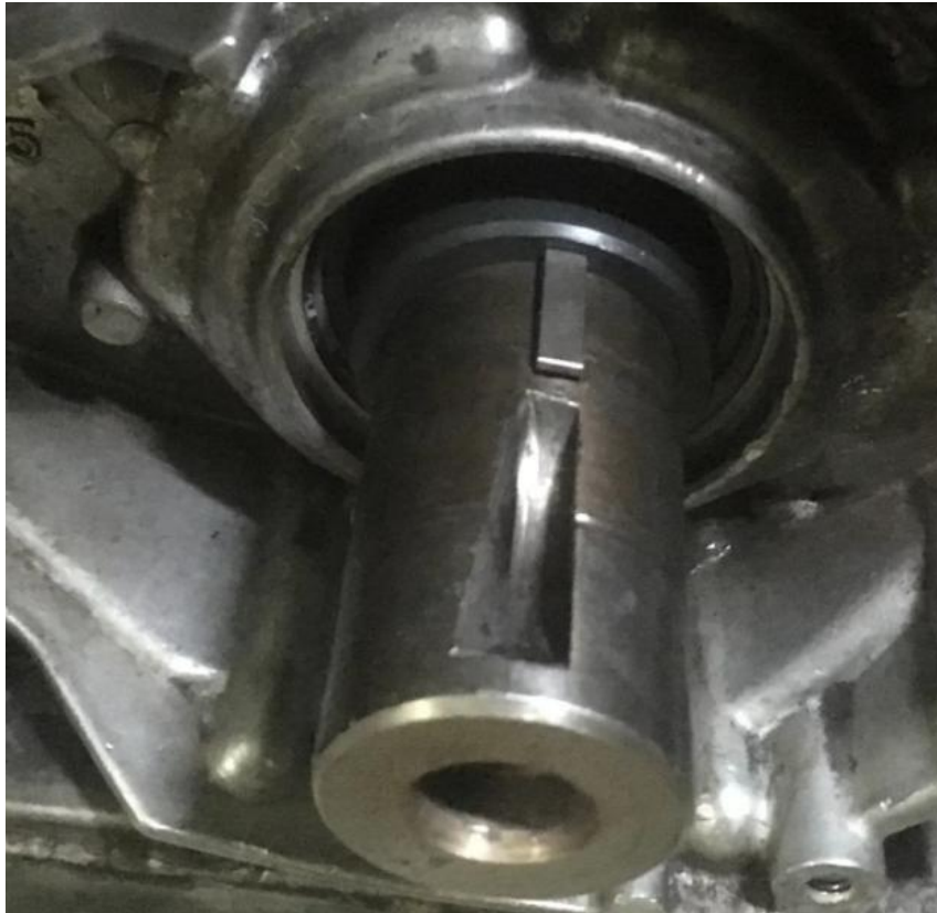
Рисунок 1.7 – Знос шпонкового пазу
