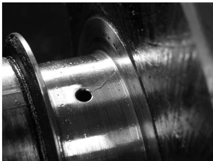
Рисунок 1.15 – Тріщина в шийці колінчатого вала двигуна КамАЗ-740
