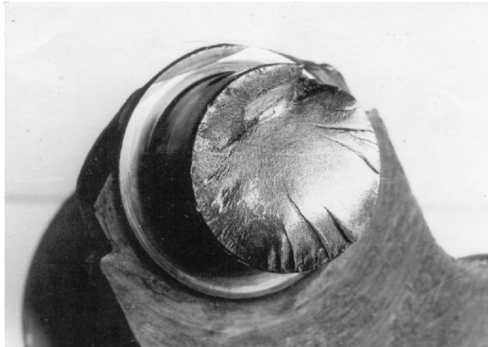
Рисунок 1.14 – Злам шийки колінчатого вала від напружень вигину
