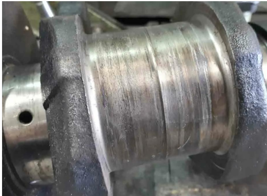
Рисунок 1.3 – Перезняття бабітового шару вкладишів на шийку валу
