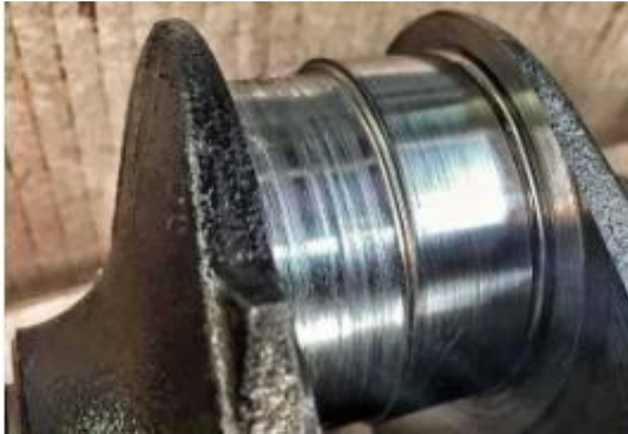
Рисунок 1.5 – Знос шатунної шийки V подібного двигуна
