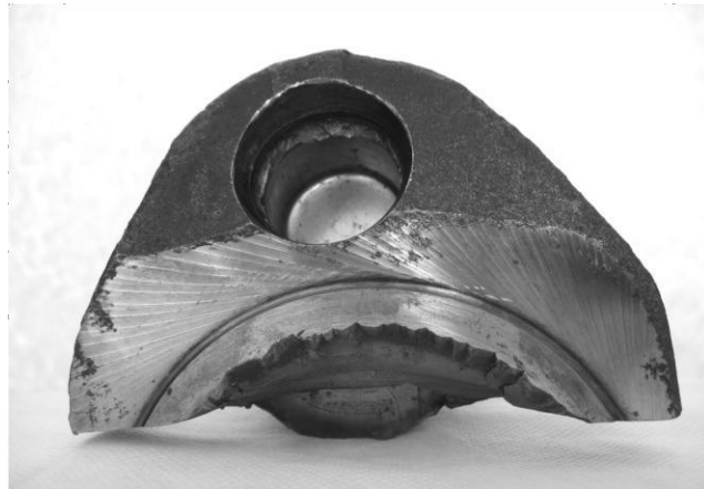
Рисунок 1.12 – Злам колінчатого вала через множинні втомлювані тріщини в області щоки
