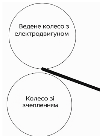
Рисунок 2.7 – Схема роботи шківів з електродвигуном .
