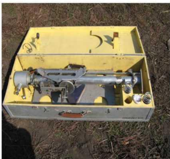
Рисунок 3.7 - Визначення твердості ґрунту на досліджуваній ділянці
