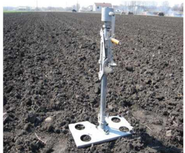
Рисунок 3.7 - Визначення твердості ґрунту на досліджуваній ділянці
