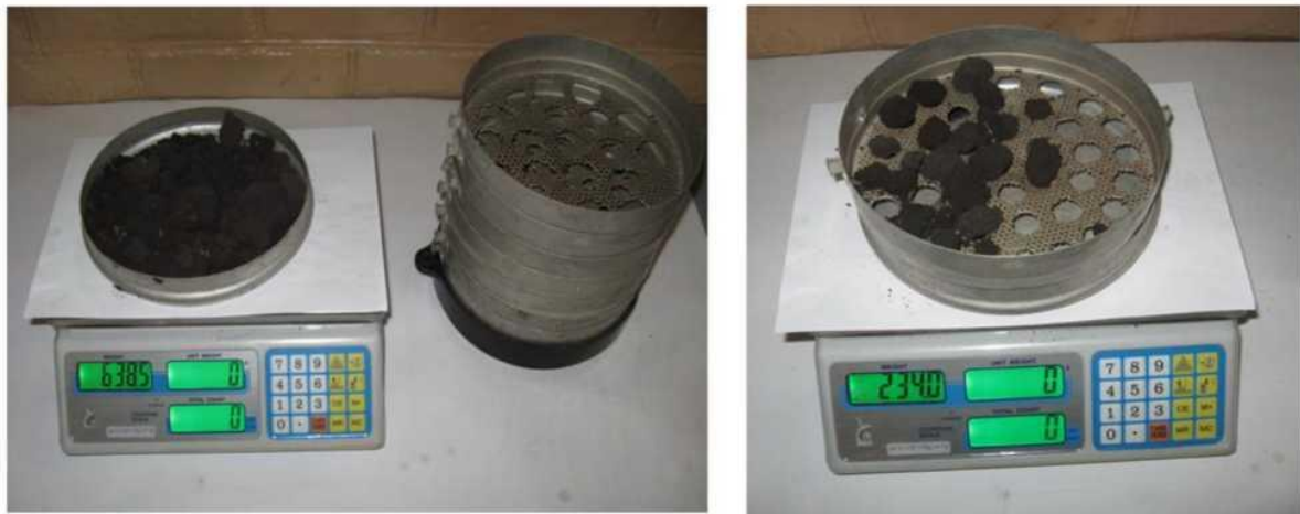
Рисунок 3.6 - Визначення структурно-агрегатного складу ґрунту
