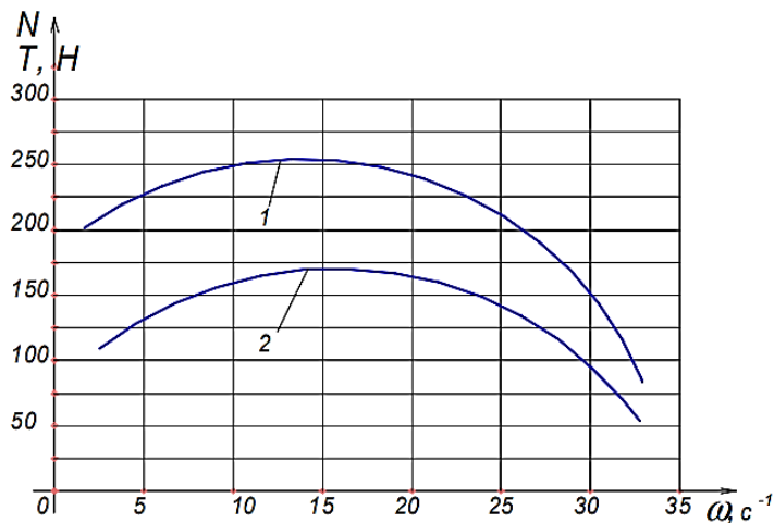
Рисунок 2.4 – Залежність сили зчісування T (1) та нормальної реакції N (2) від кутової швидкості обертання гофросмужного ворсу.
