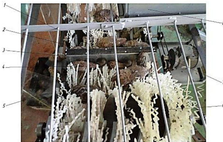
Рисунок 3.6 – Технологічна купа в робочому обсязі установки: 1 – каміння; 2 - регульована заслінка; 3 – грудки; 4 – коренеплоди буряків; 5 – заслінка; 6 – гофрощіткові барабани; 7 – привід; 8 - бункер
