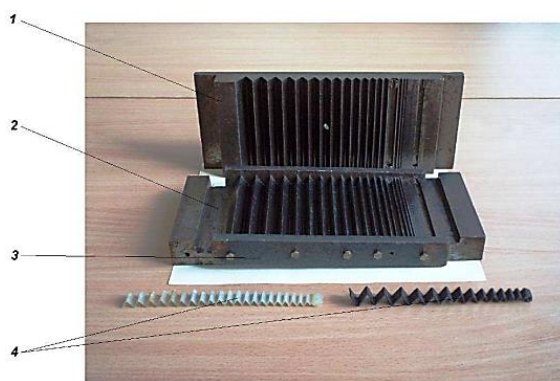
Рисунок 3.11 – Вигляд загальних прес-форм для виготовлення гофроштіткових смужок термічним способом: 1 – верхня частина прес-форми; 2 – основа прес-форми; 3 – фіксатори; 4 – гофровані смужки.
