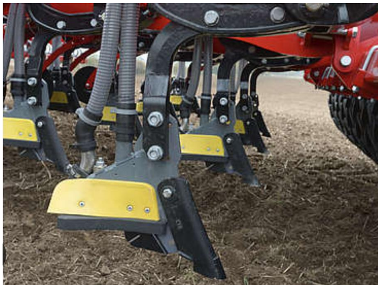
Рисунок 1.2 – Лапові сошники з розсікачами та дворівневим розподілом
