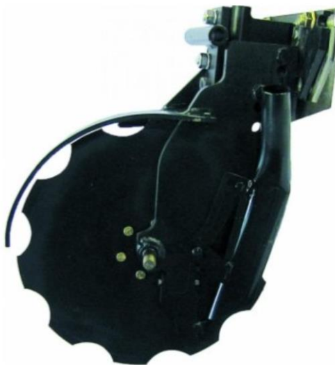
Рисунок 1.1 – Дводисковий сошник із зміщеними дисками та внутрішнім тукопроводом
