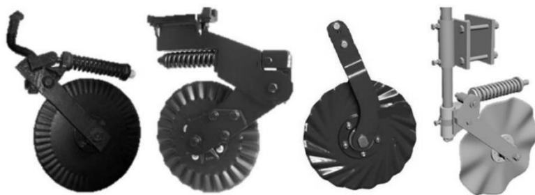
Рисунок 1.10 – Види кріплення переднього диска
