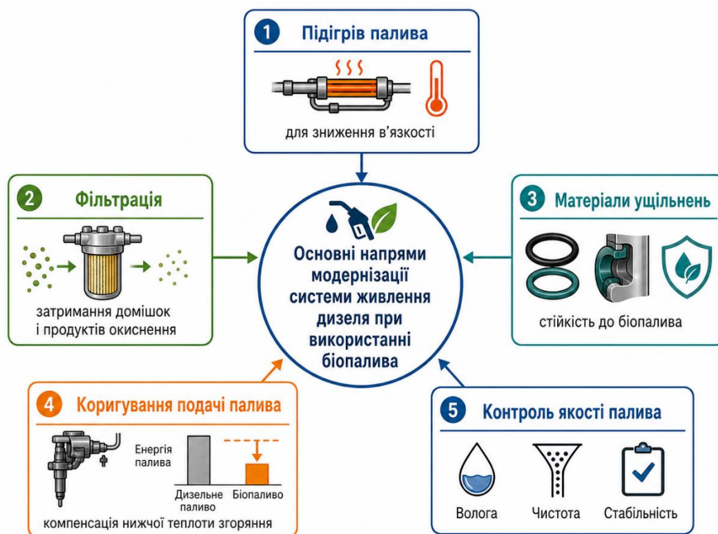
Рисунок 1.4 – Основні напрями модернізації системи живлення дизеля при роботі на біопаливі
