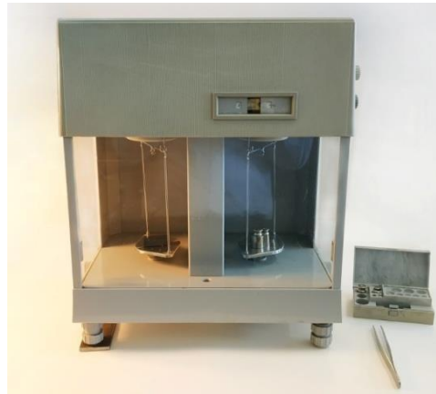
Рисунок 2.8 – Ваги ВЛР-200 г для зважування зразків
