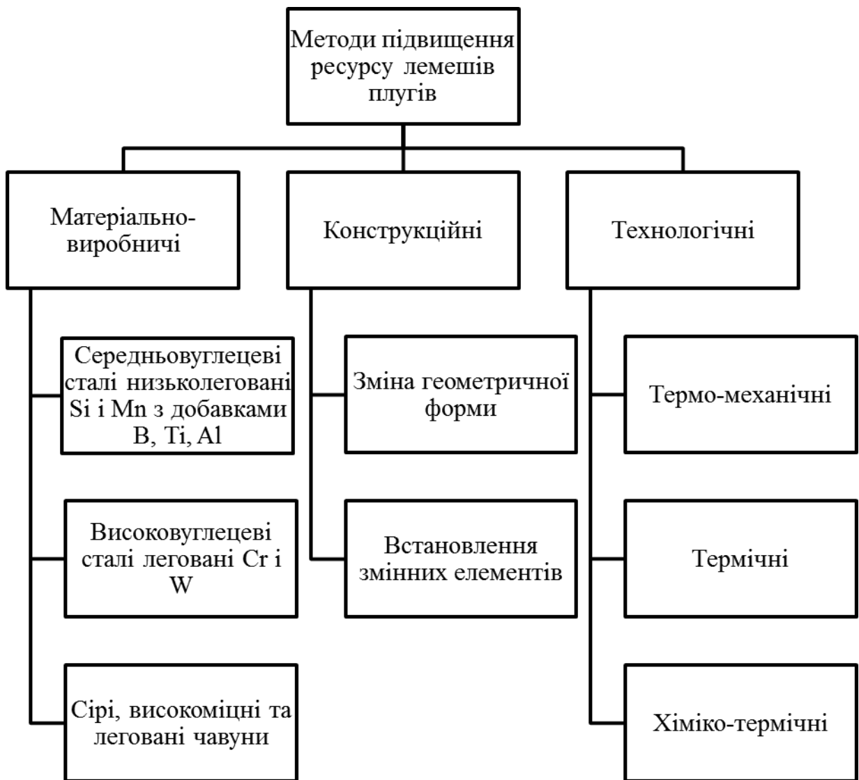
Рисунок 1.5 – Методи підвищення ресурсу лемешів плугів
