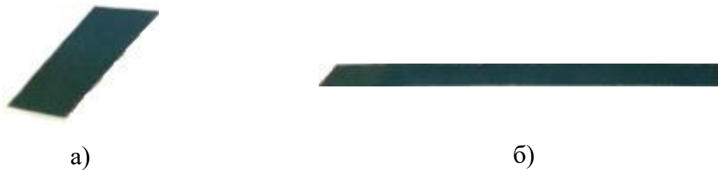
Рисунок 2.11 – Фотографії заготовок носка (а) та леза (б) лемеша плуга
