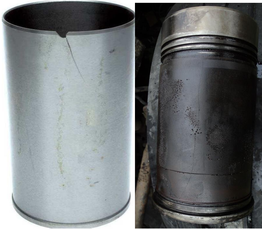
Рисунок 1.9 – Типові види тріщин у гільзі циліндра та їх локалізація в зоні максимальних напружень
