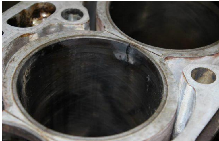
Рисунок 1.6 – Деформація типу надлому бурту гільзи: приклад пошкодження при механічних навантаженнях
