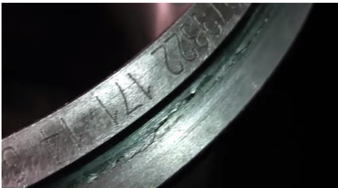
Рисунок 1.7 – Знос посадкових поясків гільзи циліндра внаслідок тривалої
