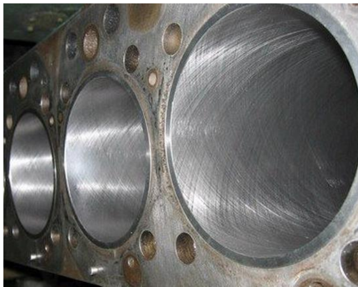
Рисунок 1.8 – Характерні зони зношування гільзи циліндра при експлуатаційних навантаженнях
