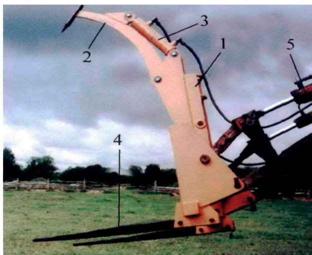
Рисунок 4.3. Вантажозахоплювальний пристрій ЗР-500: 1 - рама; 2 - притискач; 3, 5- гідроциліндри; 4 - підтримувальні пальці
