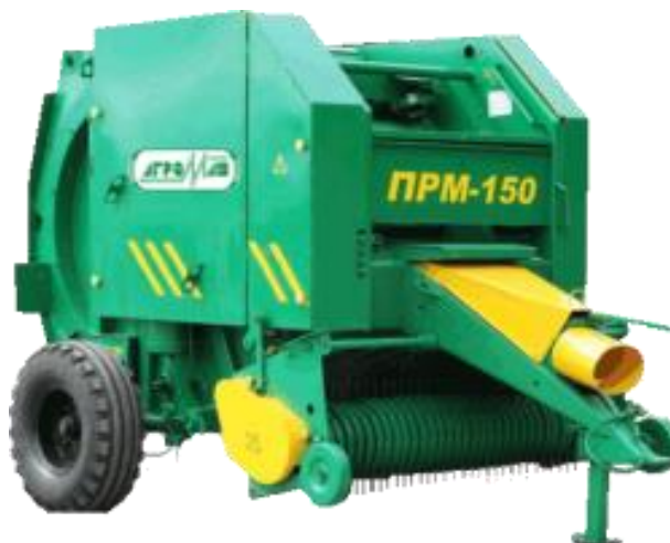
Рис. 3.1. Напівпричіпний прес-підбирач «Pelikanmax» для заготовки сіна і соломи в рулони.
