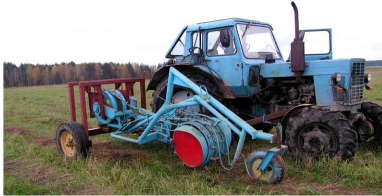
Рис. 1.7. Конструкцію навісного оборотного плуга ОЛБ-01М, що характеризується бічним розташуванням робочих елементів
