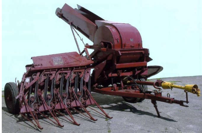
Рис. 1.1. Льонозбиральний комбайн ЛК-4А з верхнім центральним механізмом подачі стебел, який використовує дільники змінної форми
