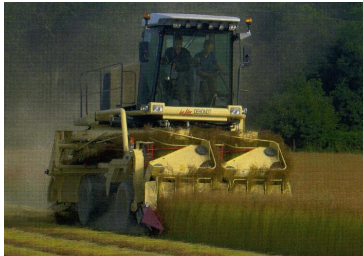
Рис. 1.2. Дворядний самохідний льонозбиральний комбайн виробництва компанії «Dehondt»
