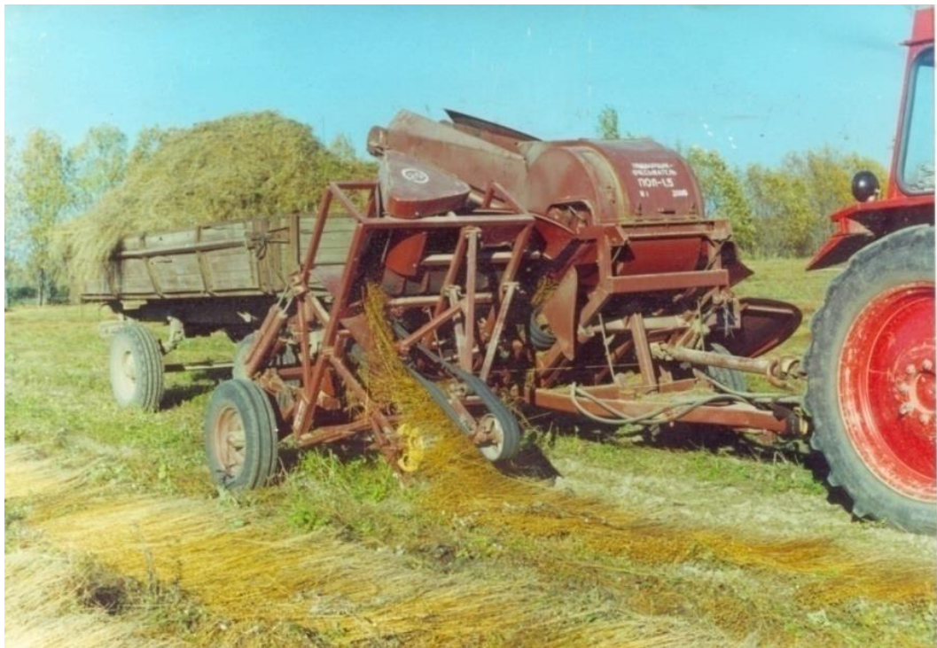
Рис. 1.4. Схематичне зображення (чи конструкцію) підбирача-очищувача моделі ПОЛ-1,5А
