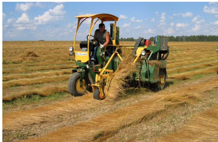
Рис. 1.6. Приклад машини ОЛС-01, що призначена для формування стрічок льону
