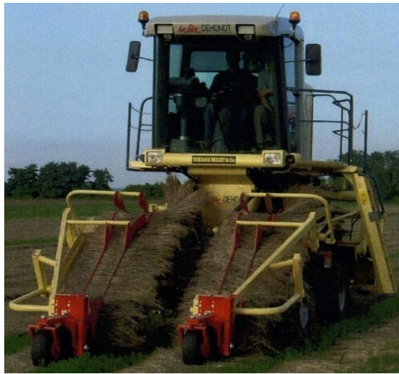
Рис. 1.5. Самохідний дворядний ворущильник льону стрічкового типу виробництва компанії « Dehondt»
