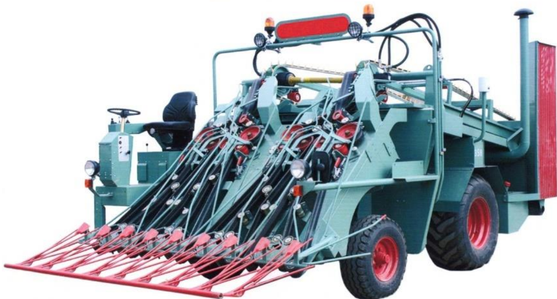
Рис. 1.3. Самохідний дворядний льонозбиральний комбайн U-22 виробництва компанії "Union"
