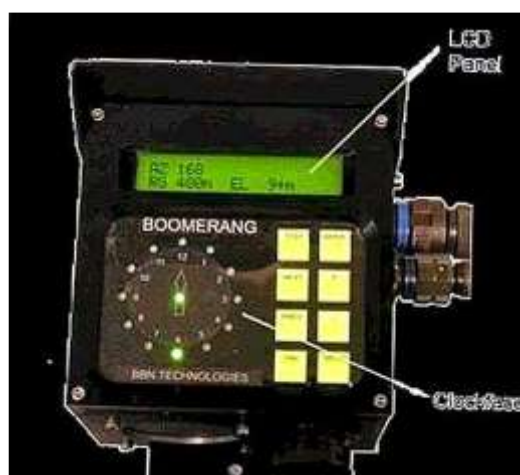
Рисунок 1.1 - Датчик системи Boomerang Warrior-X
