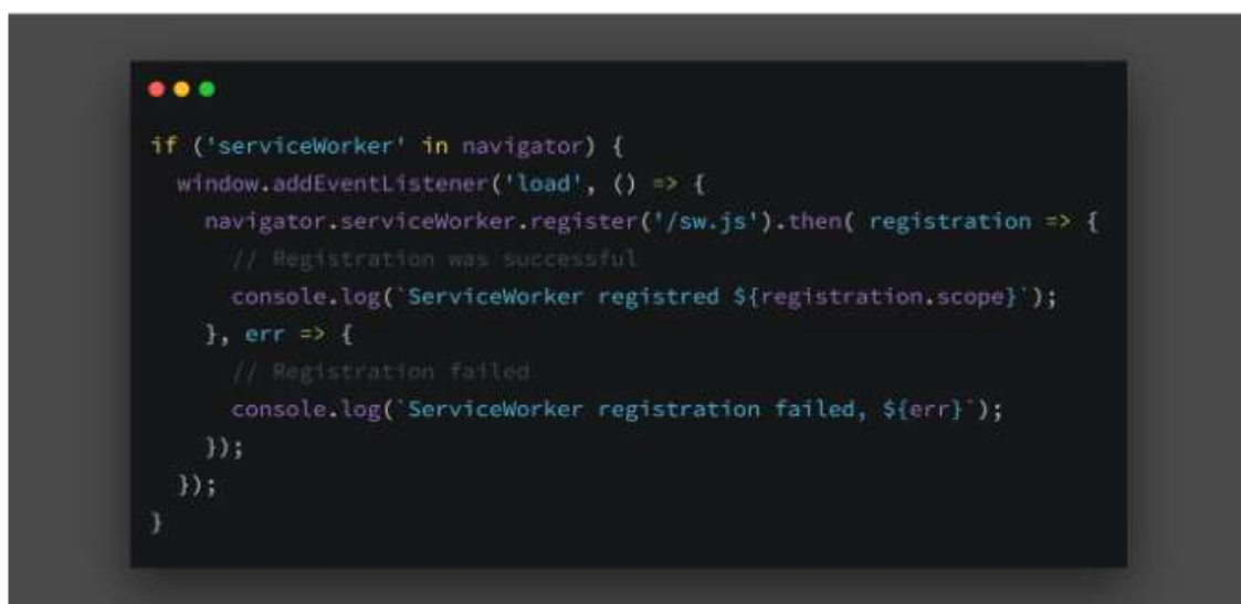
Рисунок 2.3 - Функція Service worker
